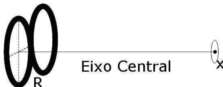
Figura 16. Esquema das medidas de campo magnético produzido pelas bobinas de TMS em função da distância, sendo R o raio da bobina e x o eixo no qual foi posicionada a sonda do fluxgate .
