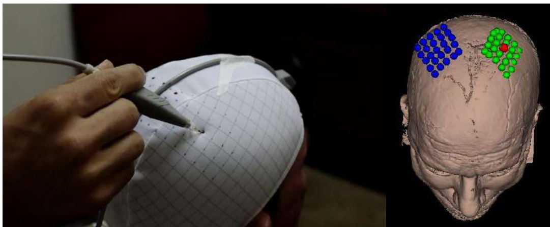
Figura 12. Exemplo de corregristo em um neuronavegador da cabeça de um voluntário com a sua respectiva reconstrução volumétrica da imagem de ressonância. Os pontos em azul e verde representam as marcações na touca e o ponto vermelho representa a posição da ponteira da sonda.
