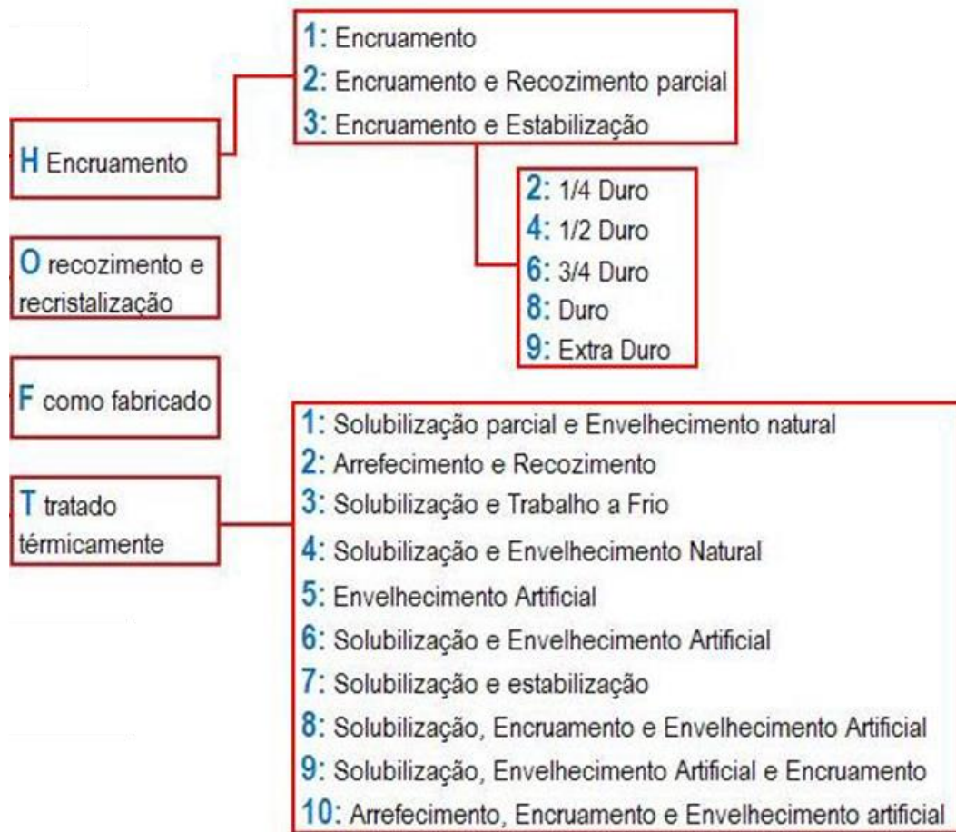
Figura 2.1. Diagrama esquemático dos diferentes tratamentos térmicos e mecânicos e a sua designação para ligas de alumínio de trabalho mecânico.
