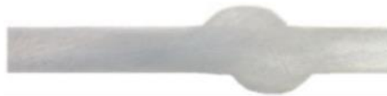
Figura 2.9. Defeito de forma numa soldadura MIG na liga de alumínio 5083-H111.
