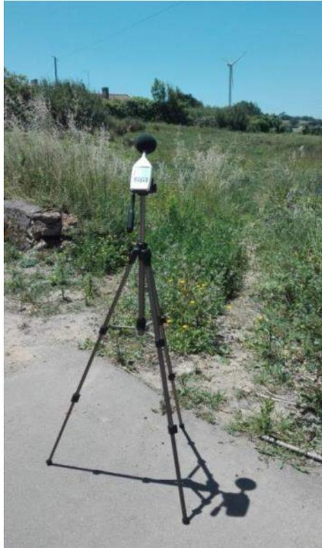
**Figura 17:** Sonómetro CESVA modelo SC420, instalado em tripé
