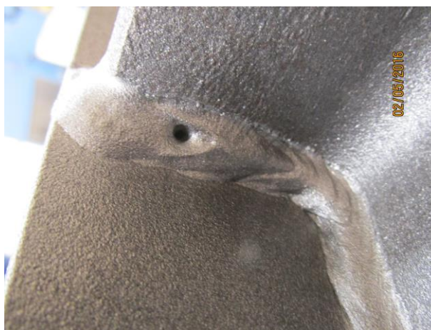
Figura 6.62 - Poro com processo MIG/MAG
