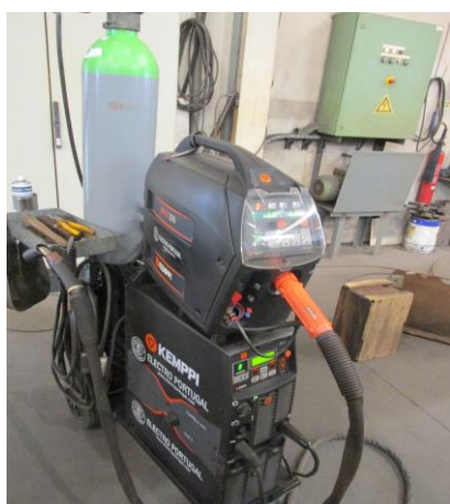
Figura 6.3 - Equipamento para soldadura com o processo MIG/MAG
