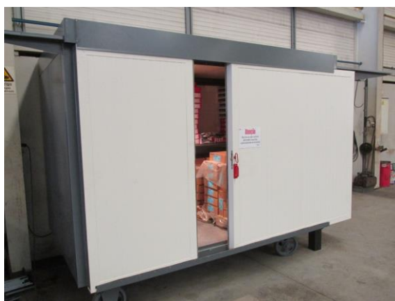
Figura 3.16 - Local próprio de armazenagem de consumíveis de soldadura
