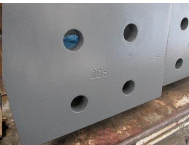
Figura 2.7 - Marcação de componentes através de punção
