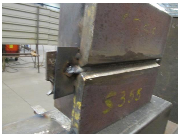
Figura 6.11 - Provete utilizado para teste de soldadura em posição PC
