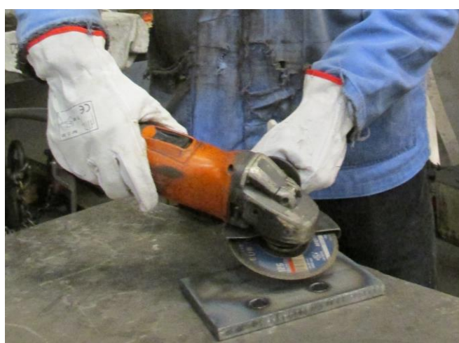
Figura 4.6 - Corte abrasivo com rebarbadora
