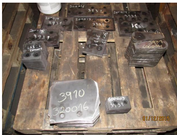
Figura 2.6 - Identificação das peças constituintes através de marcador próprio
