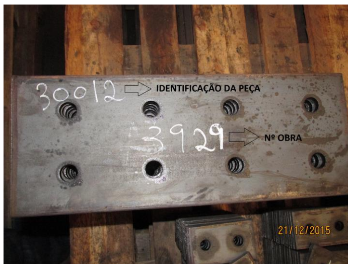
Figura 2.13 - Exemplo da identificação nas peças “30012” após fabricação
