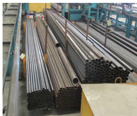
Figura 3.3 - Correto armazenamento e separação dos perfis metálicos em fábrica por tipo de secção
