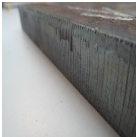
Figura 4.11 - Corte em canto (3) de espessura representativa
