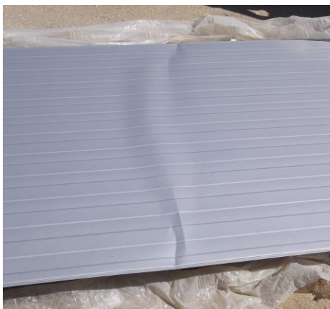
Figura 3.12 - Manipulação deficiente de painel com elevado comprimento (utilização indevida da viga de equilíbrio).
