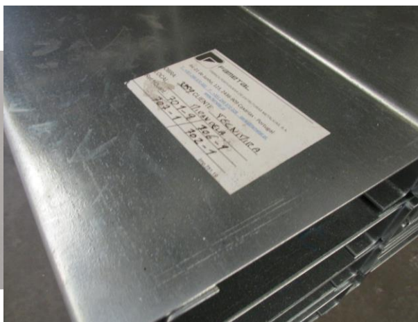
Figura 2.9 - Marcação de componentes em material galvanizado por etiquetagem
