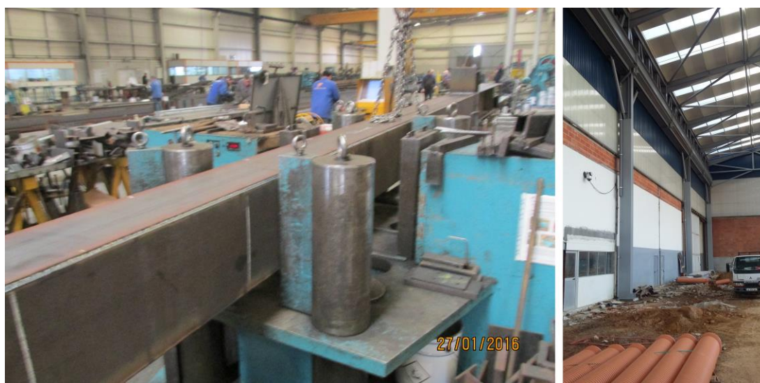
Figura 2.23 – Prensa de rolos a desempenar uma peça após ser montada em fábrica e devidamente soldada
