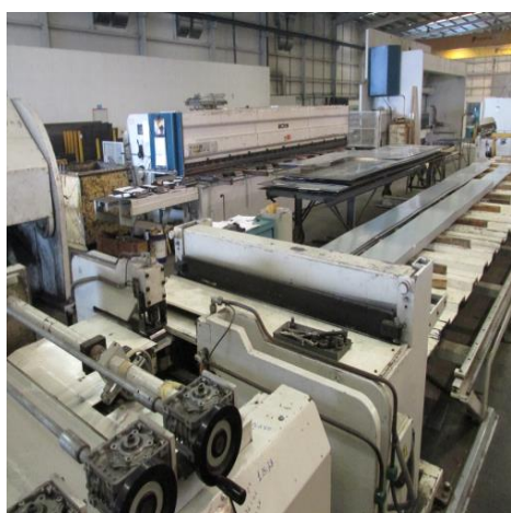
Figura 5.4 - Corte e furação de elementos de chapa fina em banda
