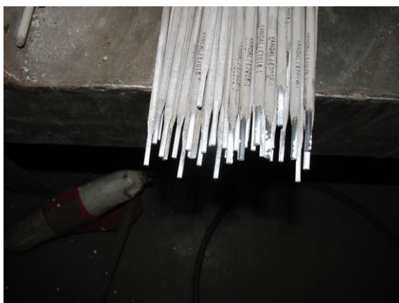
Figura 3.20 - Eléctrodos de “ponta branca” com apenas uma secagem
