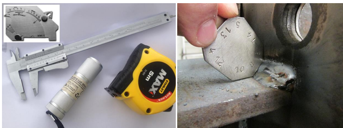
a) Escantilhão “Cambridge”, um paquímetro, uma lanterna com mais de 500 lux e uma fita métrica
