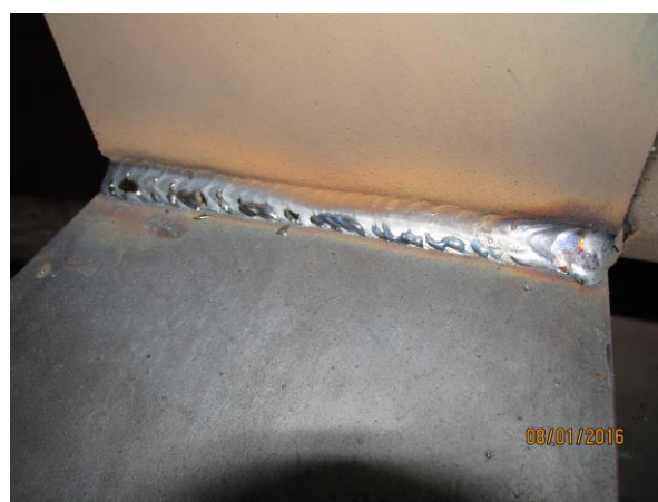
Figura 6.4 - Aspeto e morfologia do cordão obtido através do processo MIG/MAG
