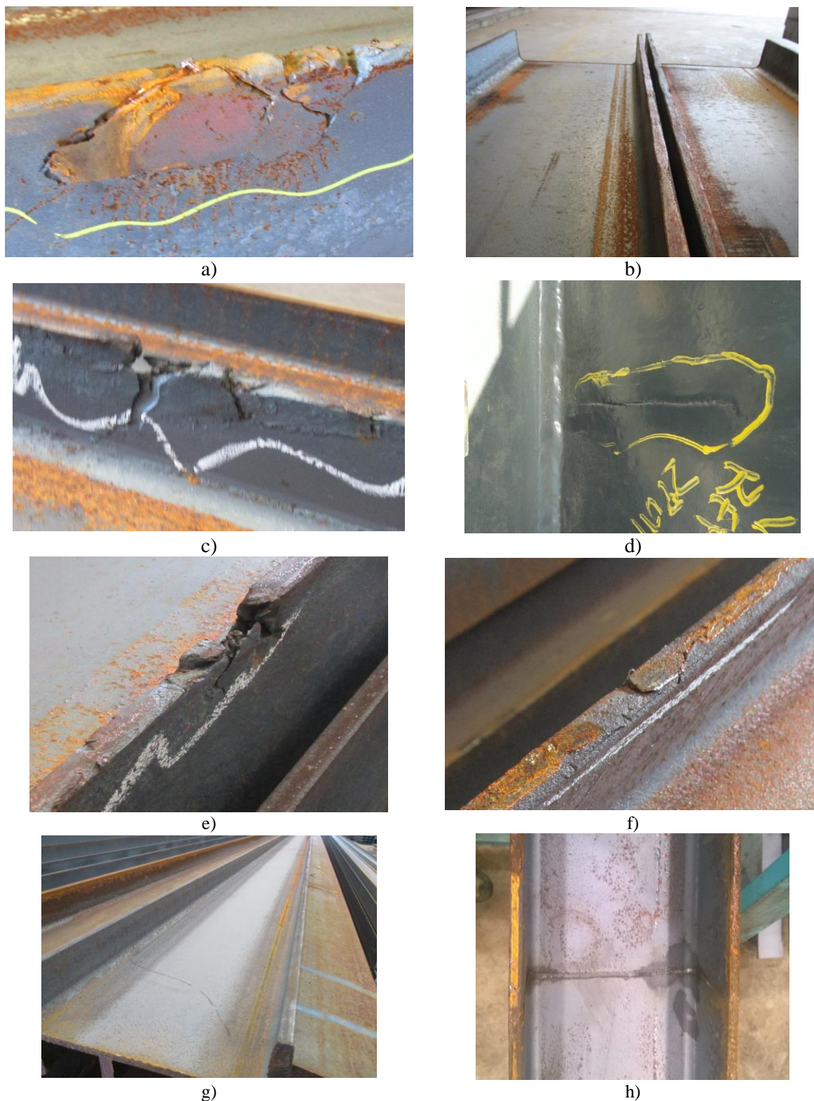
Figura 2.30 - Outras discontinuidades da laminagem (costuras, riscos, danos e marcas transversais provocadas pela passagem dos rolos, etc...)
