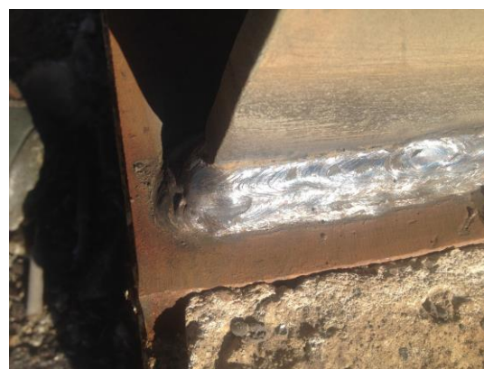
Figura 6.6 - Aspeto e morfologia do cordão obtido através do processo SER
