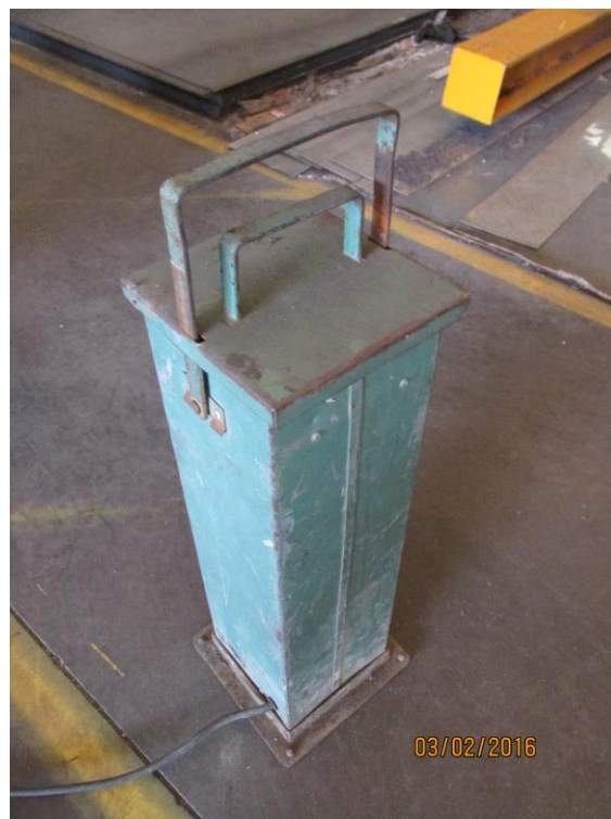
Figura 3.23 - Estufa portátil de manutenção
