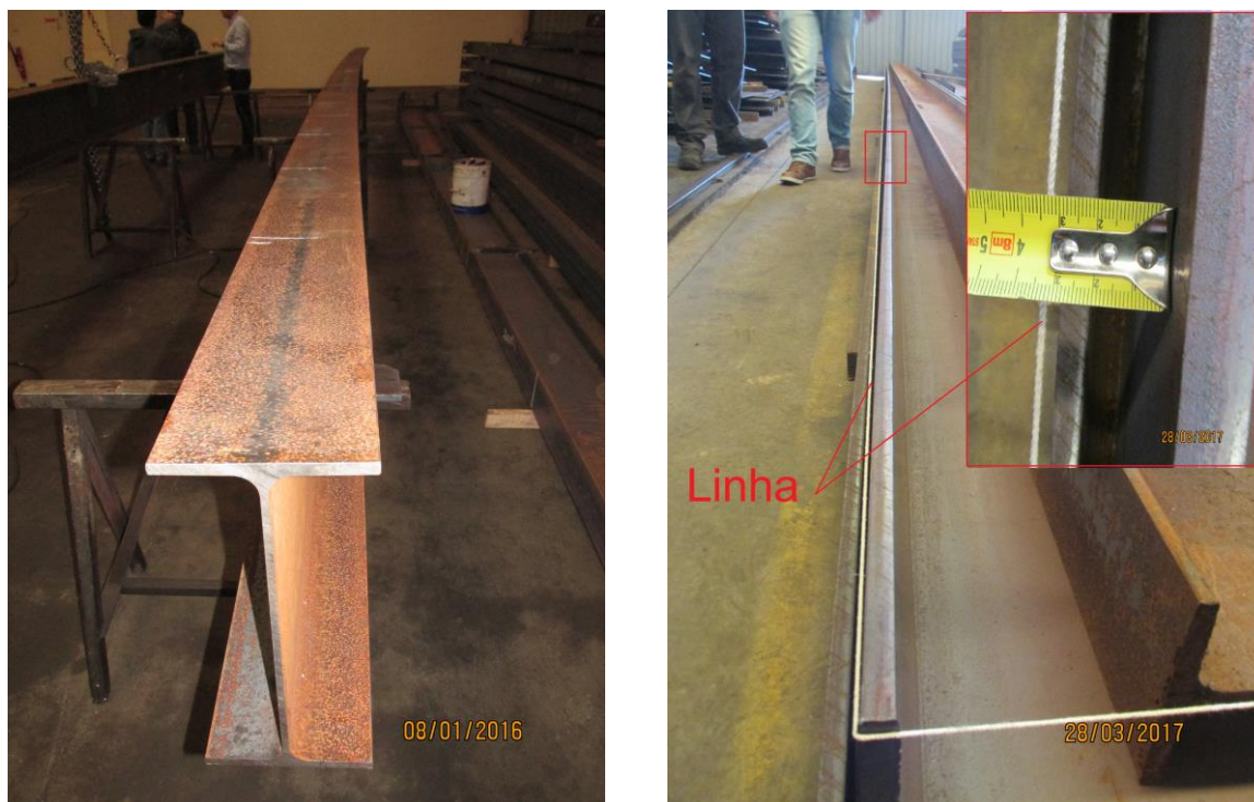
a) b) Figura 2.21 – Perfis com curvatura inicial acentuada
