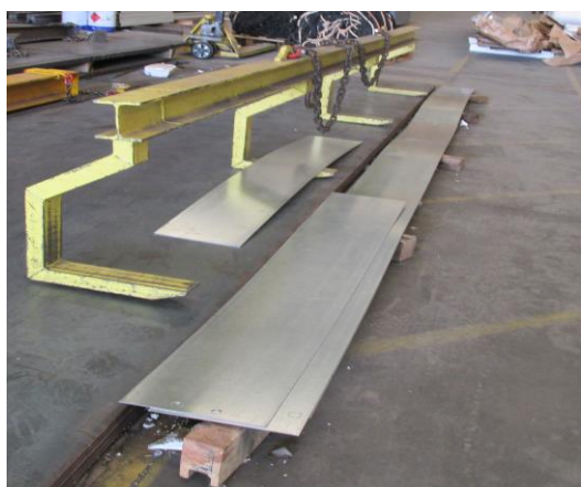
Figura 3.4 - Correta manipulação das bandas de chapa fina em fábrica antes da quinagem com o auxílio de vigas de equilíbrio
