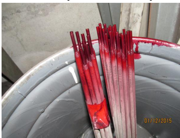
Figura 3.21 - Eléctrodos de “ponta vermelha” colocados em recipiente próprio prestes a ser retirados da zona de produção
