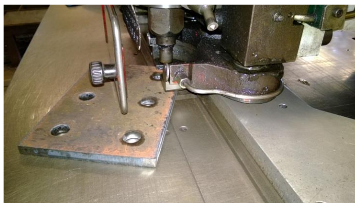
Figura 4.9 - Peça devidamente limpa e preparada para “encostar totalmente” na guia do equipamento de furação
