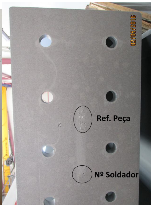
Figura 6.21 - Exemplo de punçoamento do número identificativo do soldador numa peça soldada
