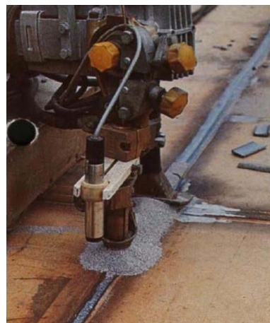
Figura 6.8 - Aspeto e morfologia do cordão obtido através do processo SAS
