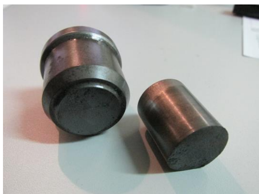
Figura 5.10 - Exemplo de punção danificado em serviço
