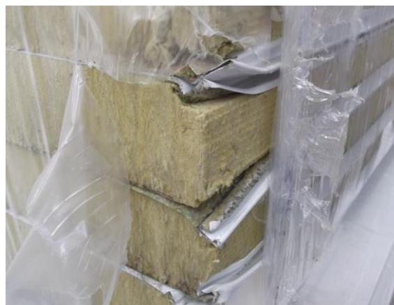
Figura 3.13 - Acondicionamento deficiente durante o transporte.
