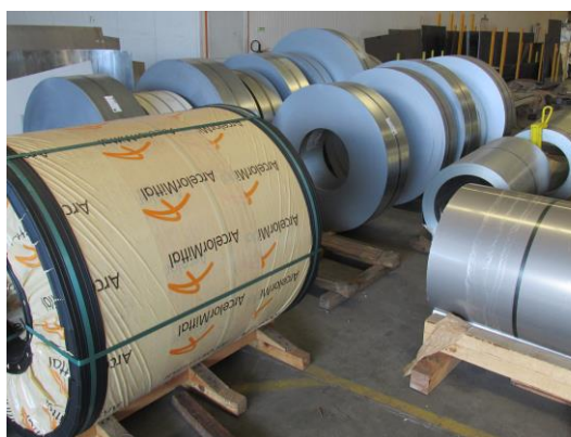
Figura 3.2 - Correto armazenamento das bobinas de chapa em fábrica por dimensão e por classe
