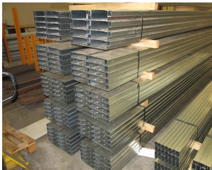
Figura 3.7 - Correto armazenamento e separação de perfis enformados a frio com auxílio de “abraçadeiras” metálicas
