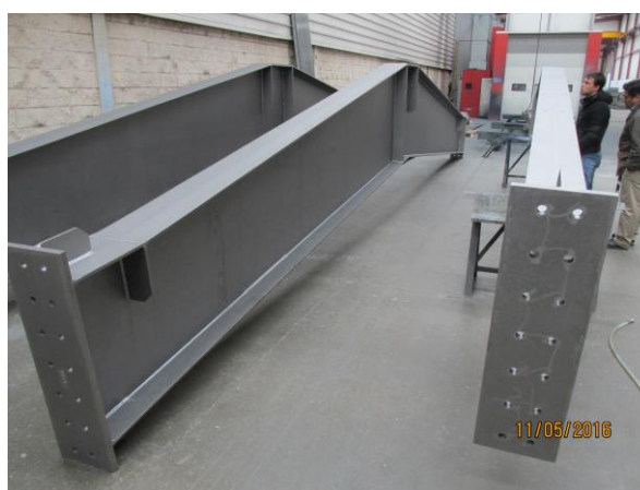
Figura 6.45 - Exemplo de asnas com banzos ligeiramente fora de esquadria
