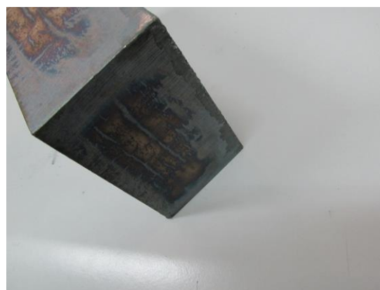
Figura 4.19 - Exemplo da peça mais espessa (provete 2- 60 mm) utilizada no ensaio
