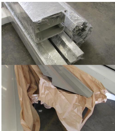
Figura 3.6 - Correto embalamento e proteção dos enformados a frio após quinagem com películas, filmes de proteção e rolos de papel
