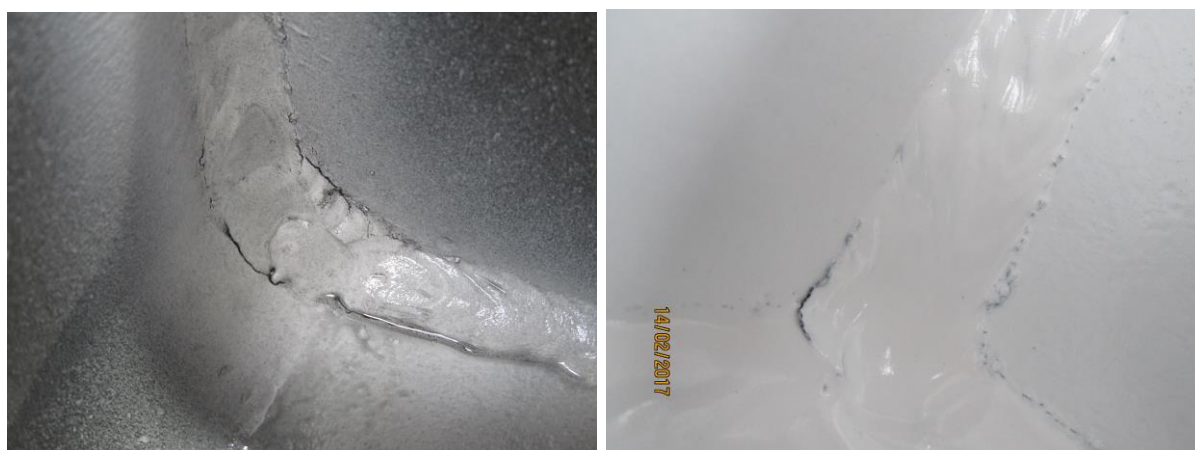
a) Confirmação com partículas magnéticas
