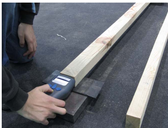
Figura 31 – Realização do ensaio MTG
