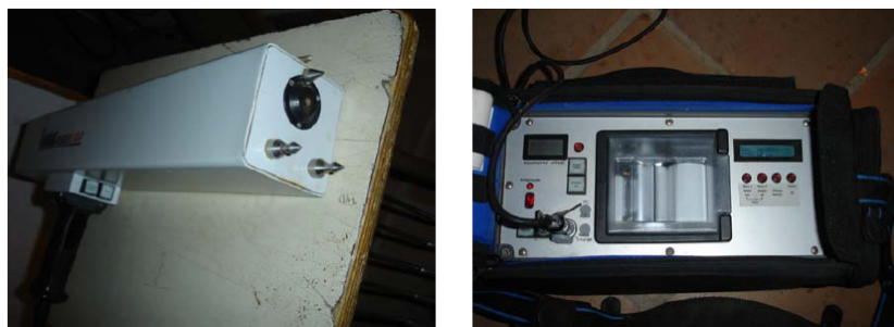
Figura 9 – À esquerda o corpo central do resistógrafo e à direita a impressora portátil (Botelho Júnior 2006)
