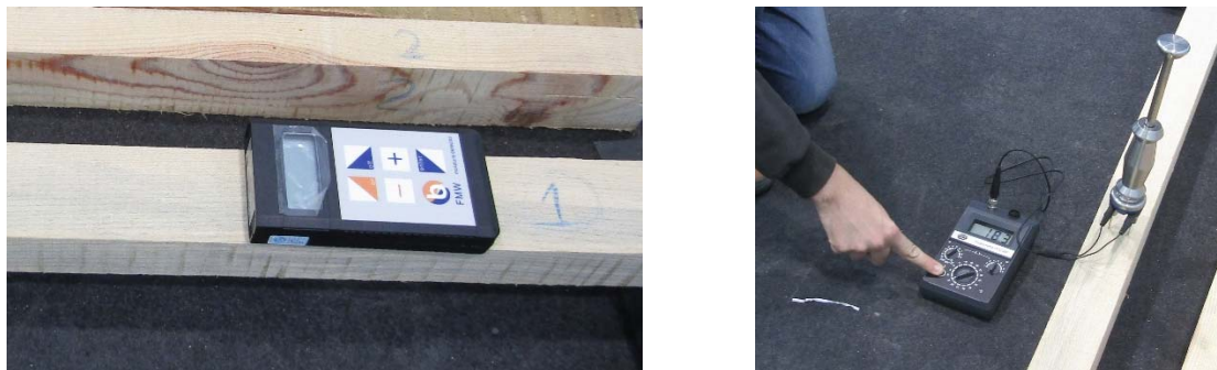
Figura 10 – Humidímetro de contacto à esquerda e humidímetro de agulhas à direita
