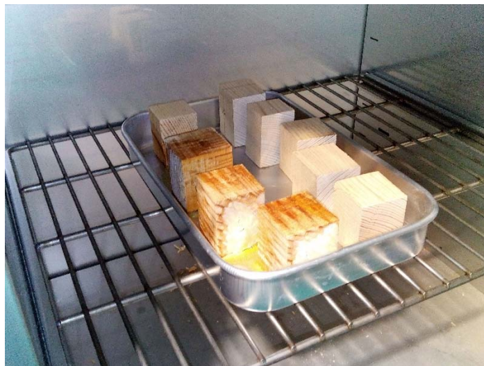
Figura 47 – Colocação da amostra na estufa
