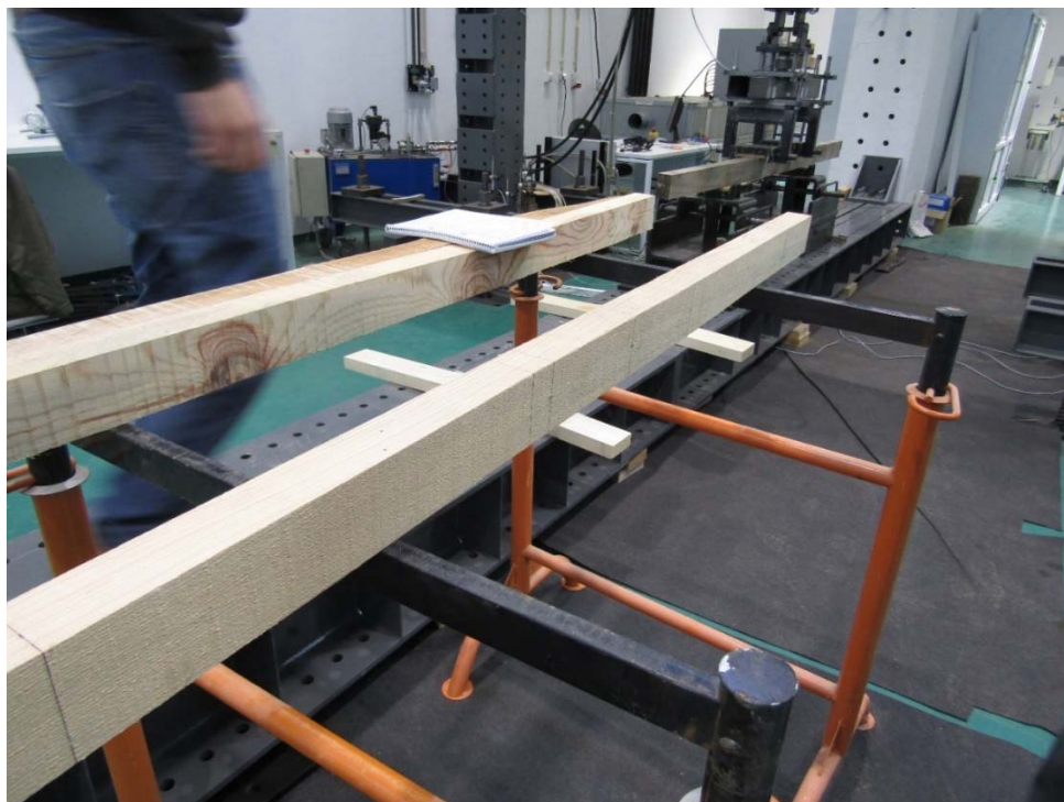
Figura 33 – Marcação prévia do provete com os locais de apoio e de fixação dos defletómetros
