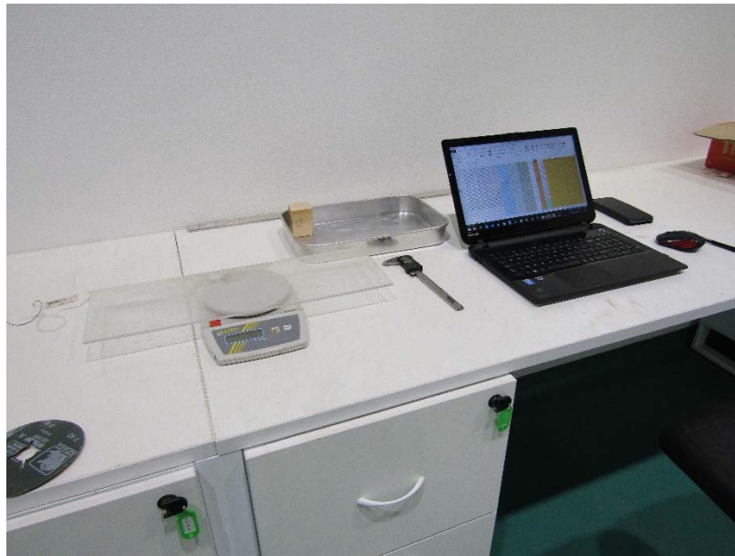
Figura 46 – Medição volumétrica da amostra e pesagem
