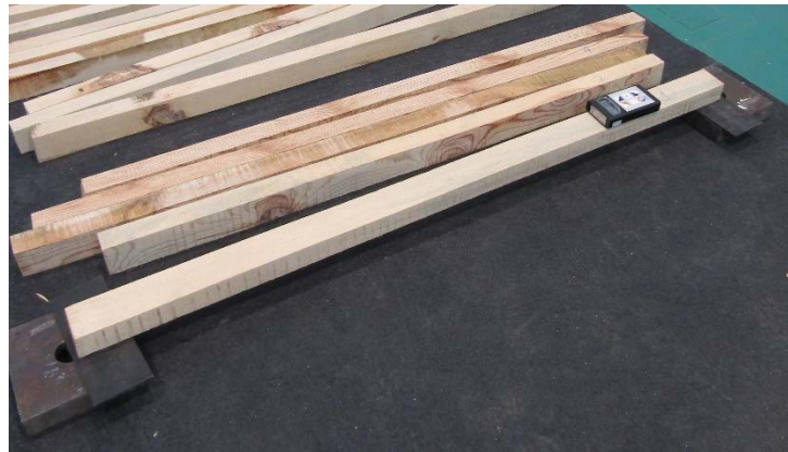
Figura 28 – Medição do teor de água com um humidímetro de contacto
