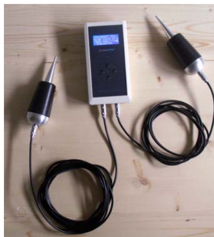
Figura 11 – Aparelho de ensaio de ultrassons Sylvatest trio (fotografia do fabricante)
