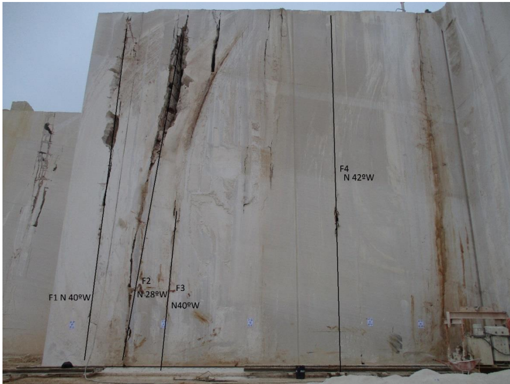
FIGURA 103-PROJEÇÃO DAS DESCONTINUIDADES FRENTE 825
