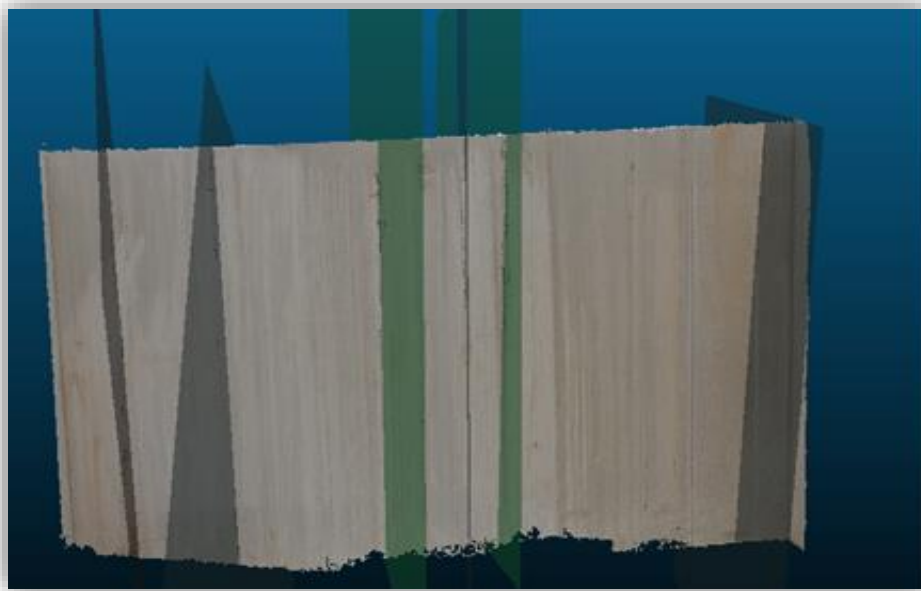
FIGURA 64-IMAGEM DO MODELO FOTOGRAMÉTRICO CRIADO E OS PLANOS DE DESCONTINUIDADE OBTIDOS PARA A FRENTE 789
