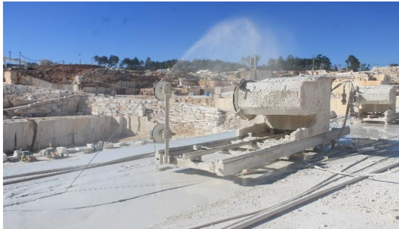
FIGURA 11-MÁQUINA DE FIO DIAMANTADO A REALIZAR O CORTE VERTICAL
