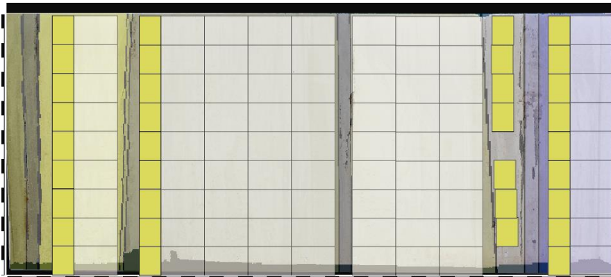
FIGURA 121-COLOCAÇÕES DOS BLOCOS MÉDIOS E REDUZIDOS
