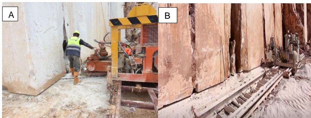
FIGURA 9- A)E B) CORTE HORIZONTAL COM O AUXÍLIO DE UM SERROTE
