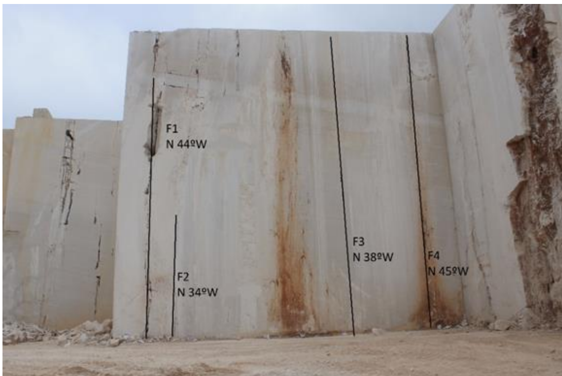
FIGURA 99-PROJEÇÃO DAS DESCONTINUIDADES FRENTE 814
