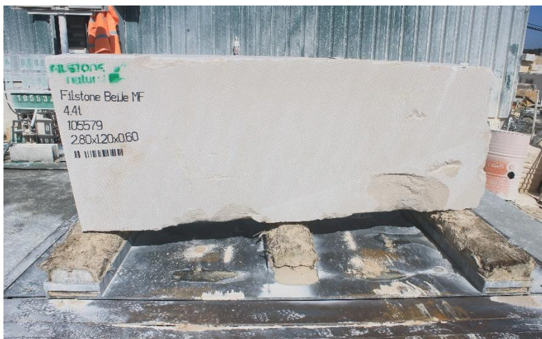
FIGURA 20-MOMENTO EM QUE O BLOCO É PESADO E IDENTIFICADO
