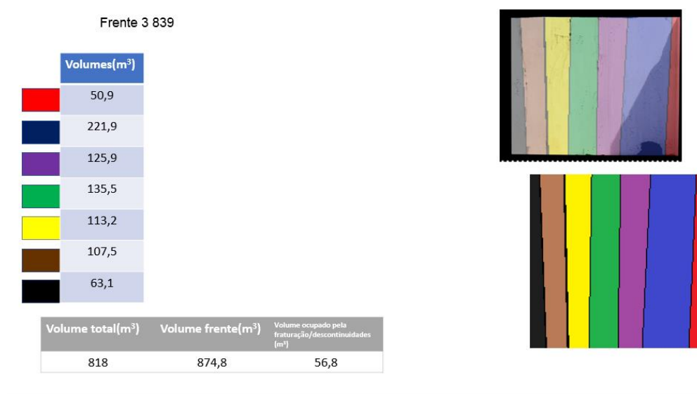
FIGURA 138- IMAGEM OBTIDA DA FRENTE 839 JUNTAMENTE COM OS VOLUMES ASSOCIADOS A CADA COR
