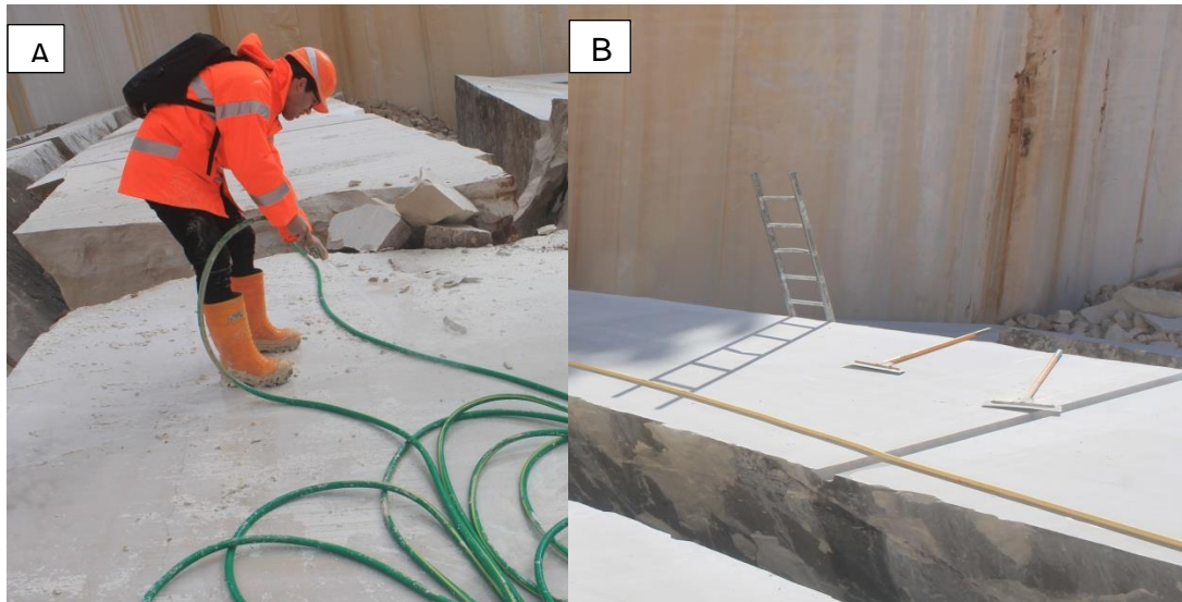
FIGURA 14-A) PROJEÇÃO DE ÁGUA E B) LIMPEZA DO PISO COM AUXÍLIO DE PÁS
