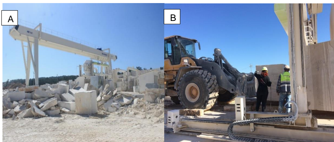
FIGURA 21 A) VISUALIZAÇÃO DO PÓRTICO B) COLOCAÇÃO DOS BLOCOS NAS MÁQUINAS DE FIO
