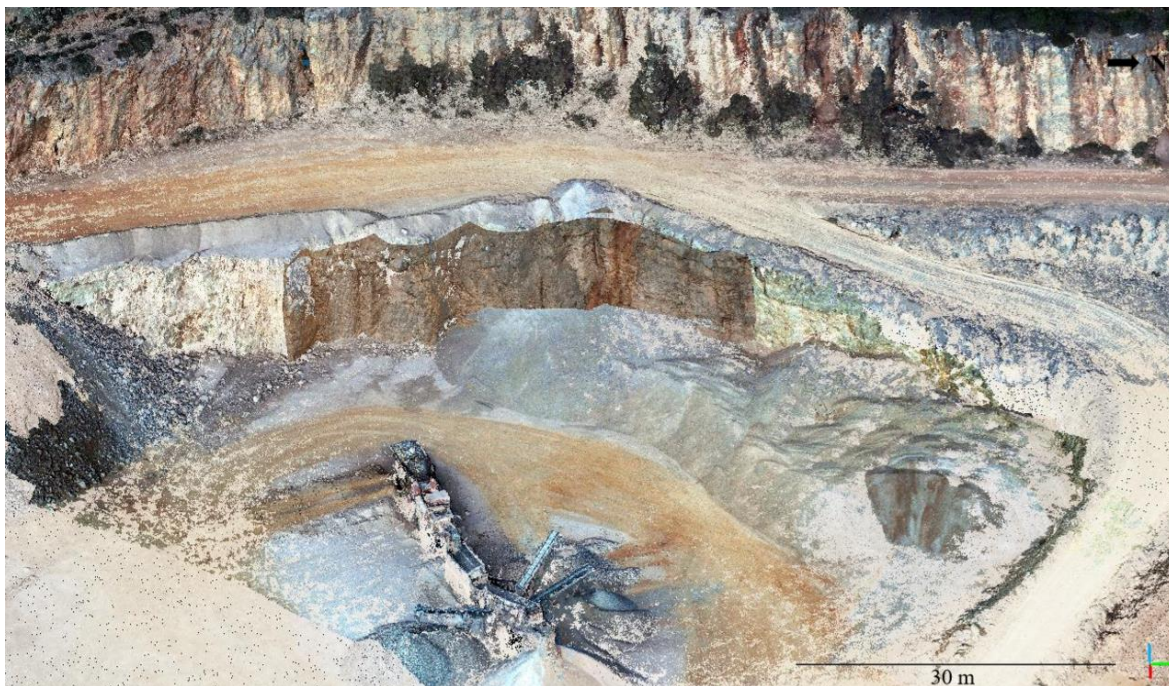
Figura 34 - Sobreposição de ambas as nuvens de pontos densas. No centro com a cor mais escura e melhor definição encontra-se a nuvem de pontos densa correspondente à frente de estudo. Na envolvente encontra-se parte da nuvem de pontos densa da pedreira.
