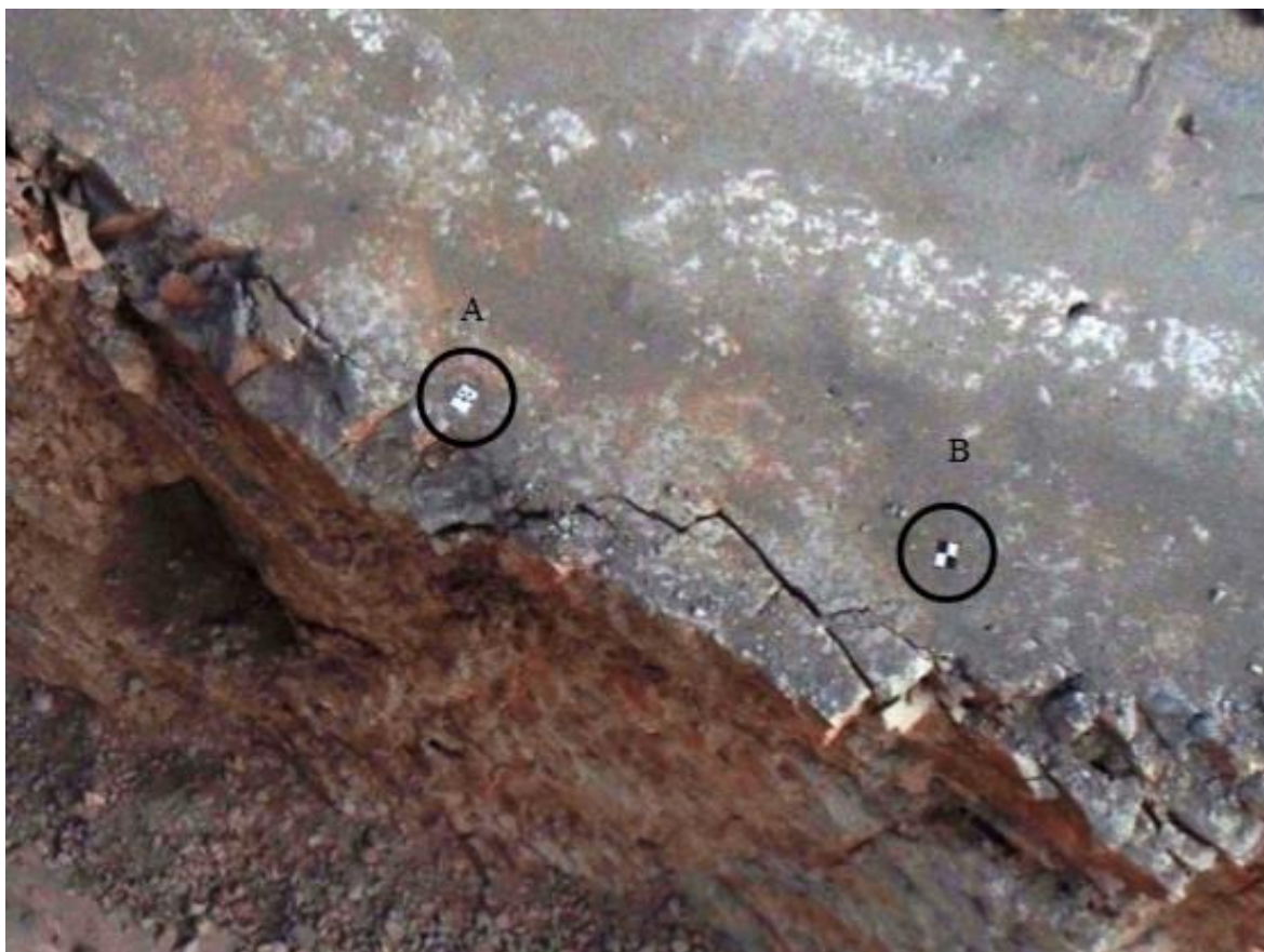
Figura 20 - Fotografia captada pelo VANT onde é visível o par de pontos de controlo em que A é o circular e B o retangular.
