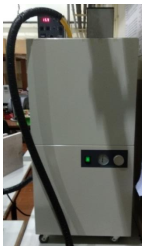
Figura 3.9 – Banho termostatzado tipo DBT KB21 da Heto Lab Equipment .
