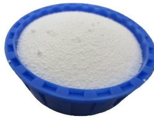
Figura 3.14 – Aspeto macroscópico do PCM microencapsulado Micronal® DS 5001 X .
