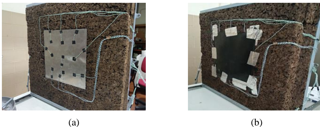
Figura 3.4 – (a) Distribuição dos 9 termopares tipo-K na superfície da placa quente. (b) Regularização da superfície de contacto através da incorporação de uma película de borracha.
