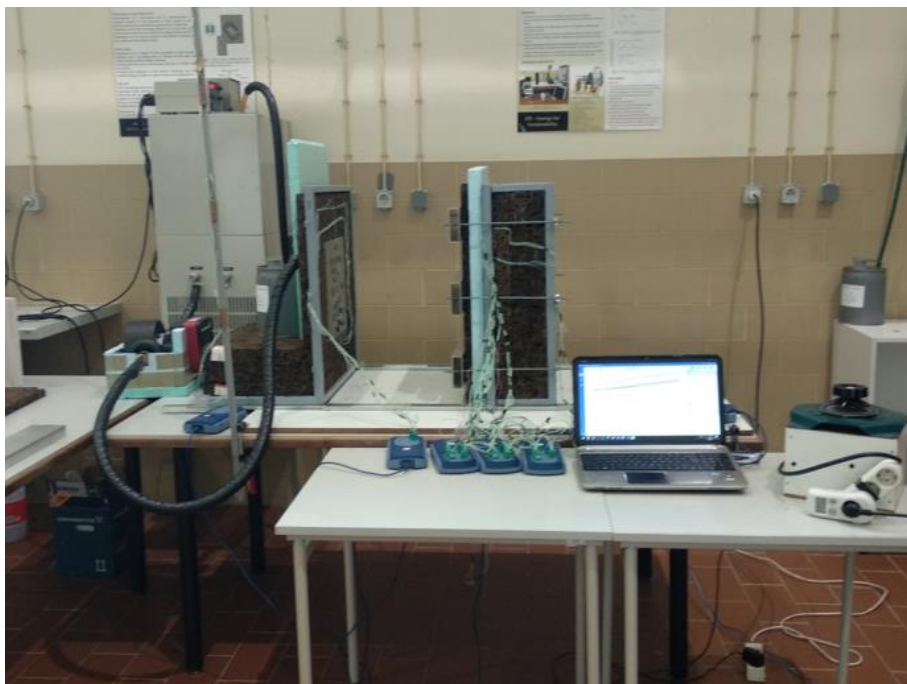
Figura IV.2 – Montagem experimental durante um ensaio de descarga.
