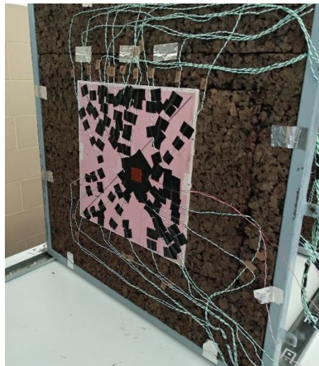
Figura 3.11 – Módulo de teste com a amostra fixa e sistema de recolha de dados acoplado.
