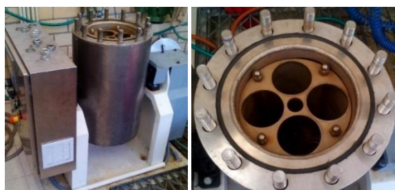
Figura 0.1. Digestor laboratorial descontínuo rotativo utilizado nos cozimentos kraft , nas instalações do RAIZ.
