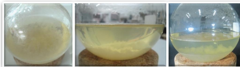
Figura 0.6. Produto obtido por oxidação da pasta Al em CDA-Al2bis, durante 3 h a 75 °C.
