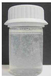
Figura 0.16. Estabilização da fase oleosa do efluente no frasco de medição, após adição de 53.19 ppm de floculante sintético.
