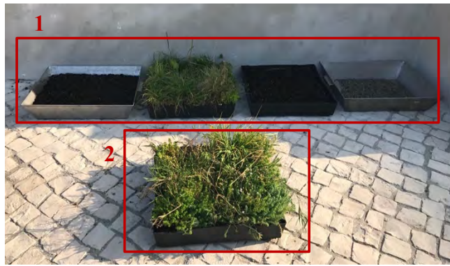
Figura 3.44 - Equipamento de pesagem e módulos ensaiados: a) Balança utilizada para as pesagens, b) Localização dos módulos: 1. TL, TS, TLFS, TLFSV2 colocados à sombra; 2. TLFSV1 colocado ao sol.
