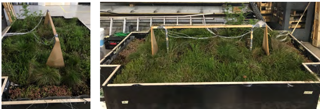
Figura 3.7- Colocação do cavalete com sondas PT100.
