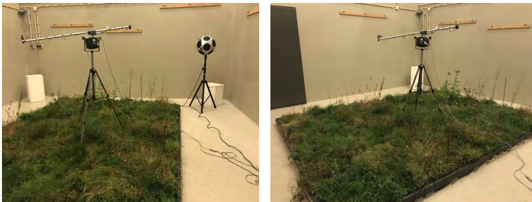
Figura 3.54 - Provete de ensaio colocado na câmara reverberante.
