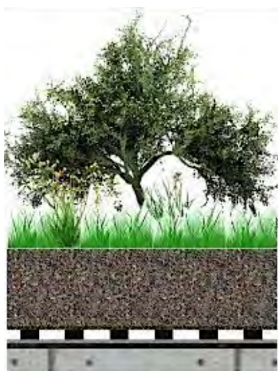
Figura 2.6 - Representação detalhada de uma cobertura verde semi-intensiva (Fonte: The European Portal for Energy Efficiency in Buildings ).
