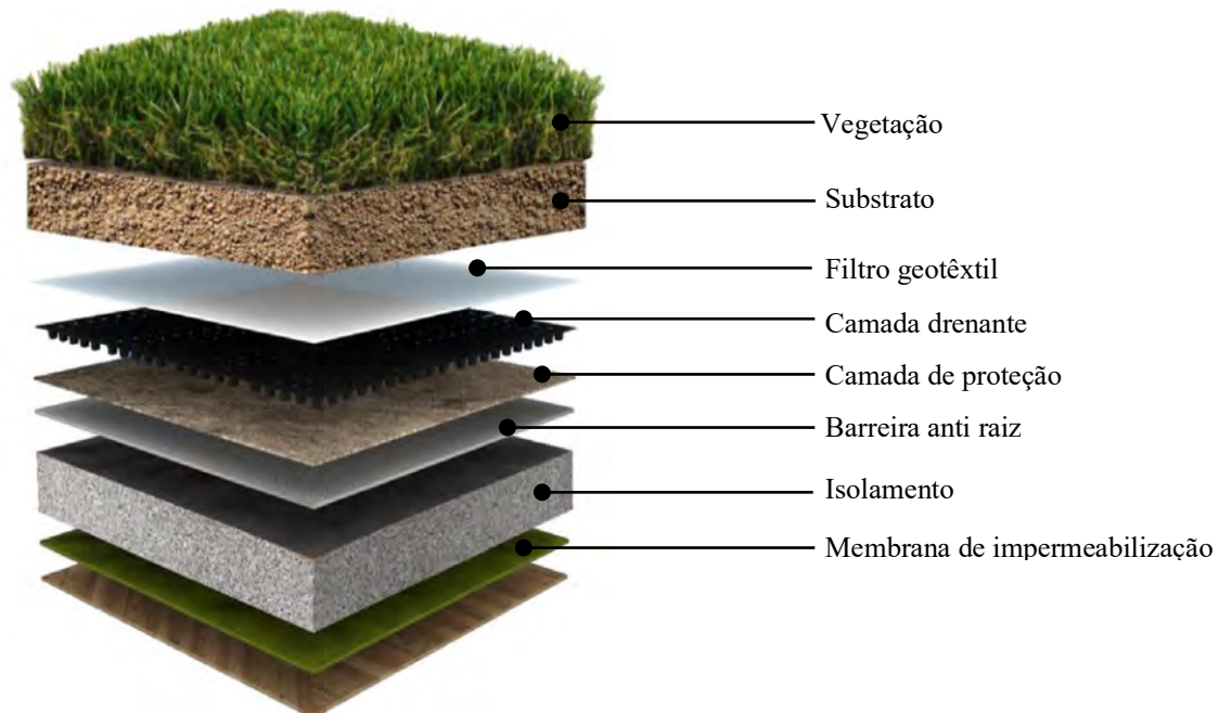
Figura 2.1 - Componentes de uma cobertura verde (Fonte: Vijayaraghavan, K., 2016).
