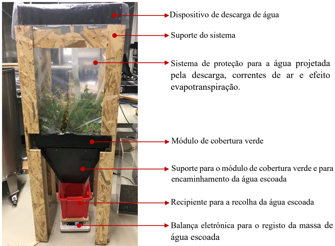
Figura 3.36 - Dispositivo experimental para ensaios de escoamento.
