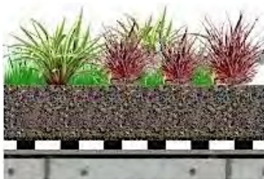
Figura 2.4 - Representação detalhada de uma cobertura verde semi-intensiva (Fonte: The European Portal for Energy Efficiency in Buildings ).
