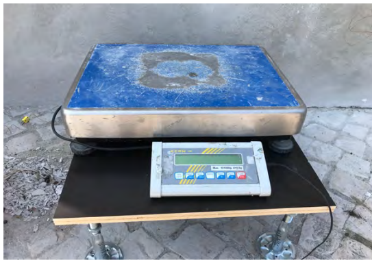
Figura 3.44 - Equipamento de pesagem e módulos ensaiados: a) Balança utilizada para as pesagens, b) Localização dos módulos: 1. TL, TS, TLFS, TLFSV2 colocados à sombra; 2. TLFSV1 colocado ao sol.
