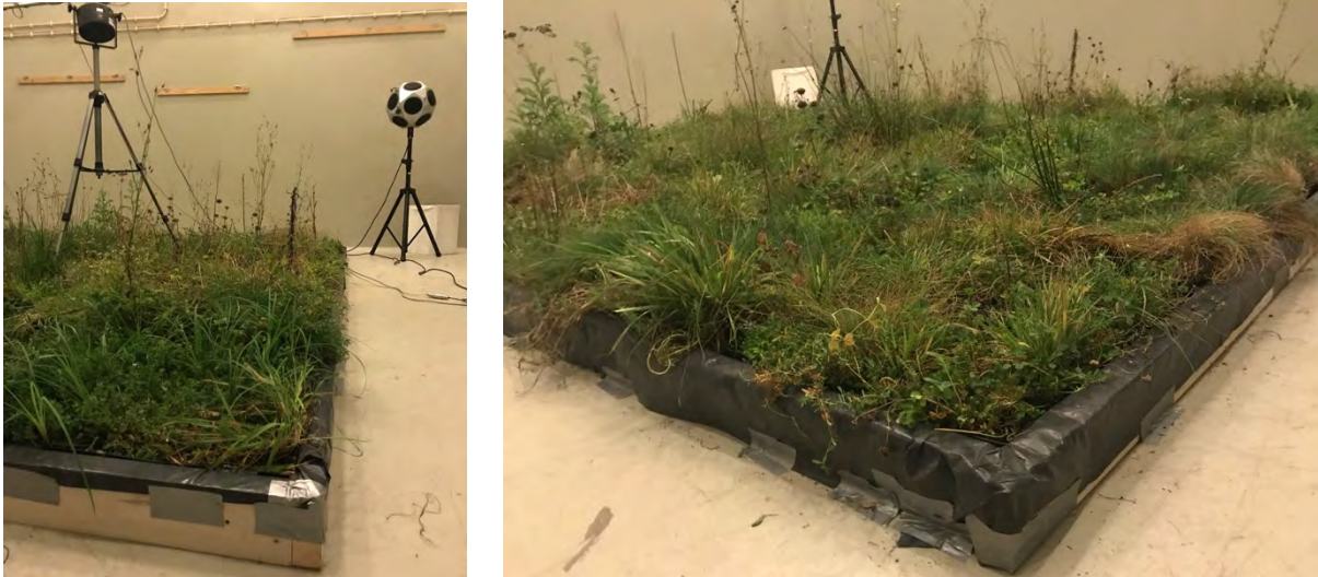
Figura 3.52 - Provede de ensaio selado com moldura acusticamente refletora.
