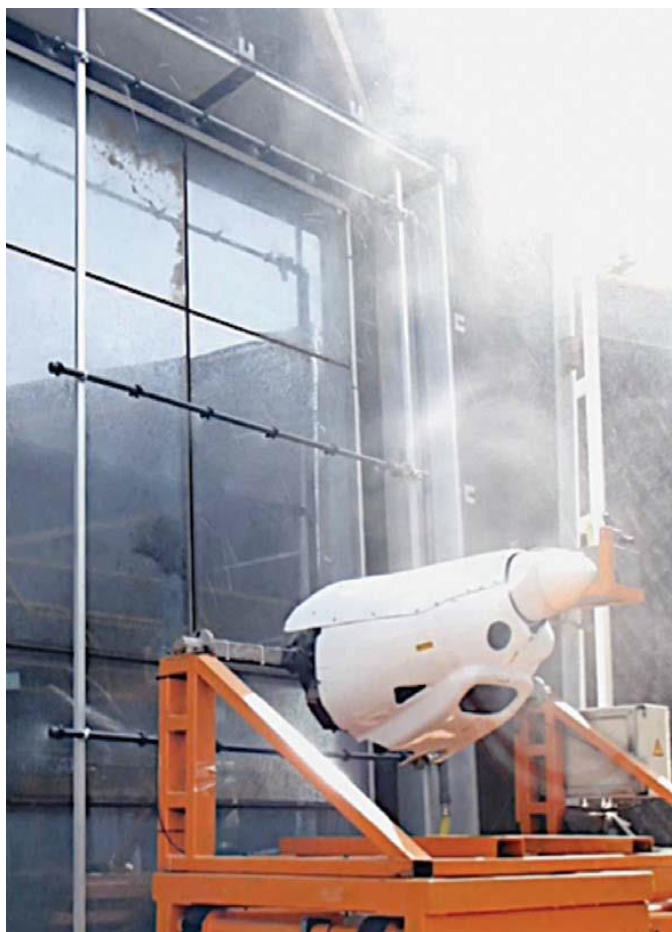
Figura 4.2 - Ensaio de infiltração de água sob pressão dinâmica (adaptado de [16]).
