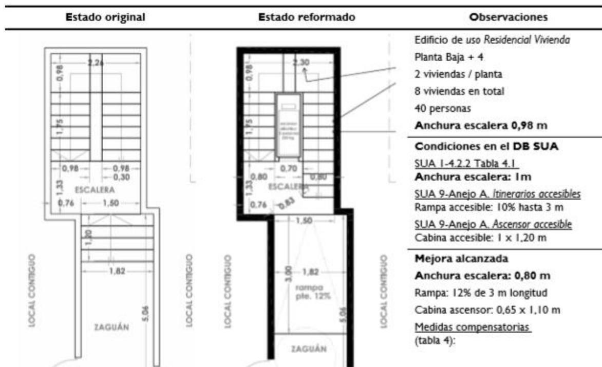
Figura 2.5: Exemplo de redução da largura da escada para melhoria da acessibilidade (UCC, 2014)
