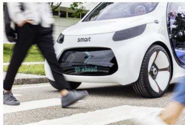
Figura 4.3 – O VA exibe uma mensagem para o peão (Daimler AG, 2017a).
