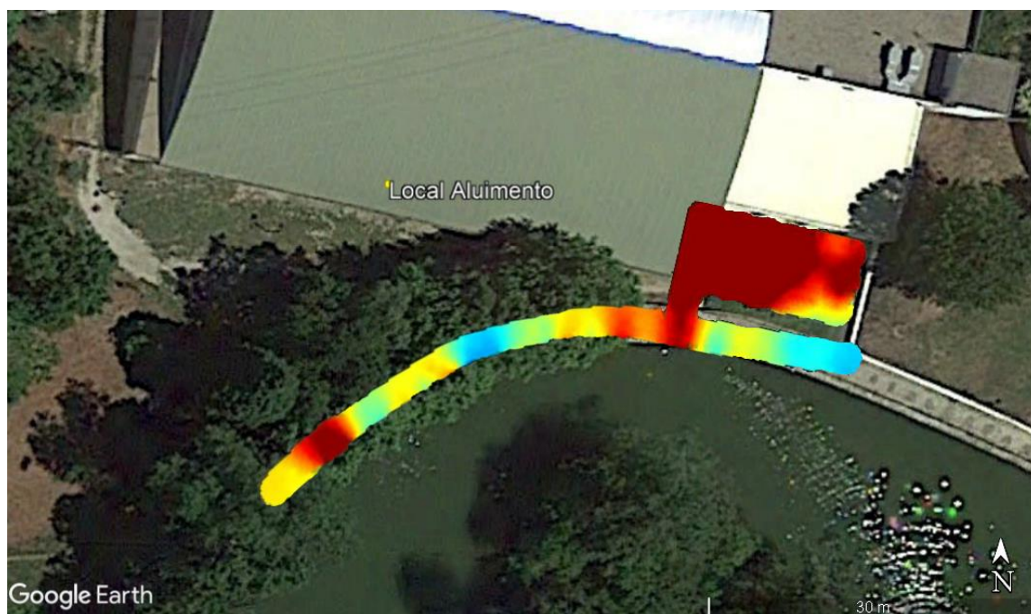
Figura 59 - Zona C - Slice view a 3.5 metros de profundidade (EKKO Project v.5 e Google Earth Pro).
