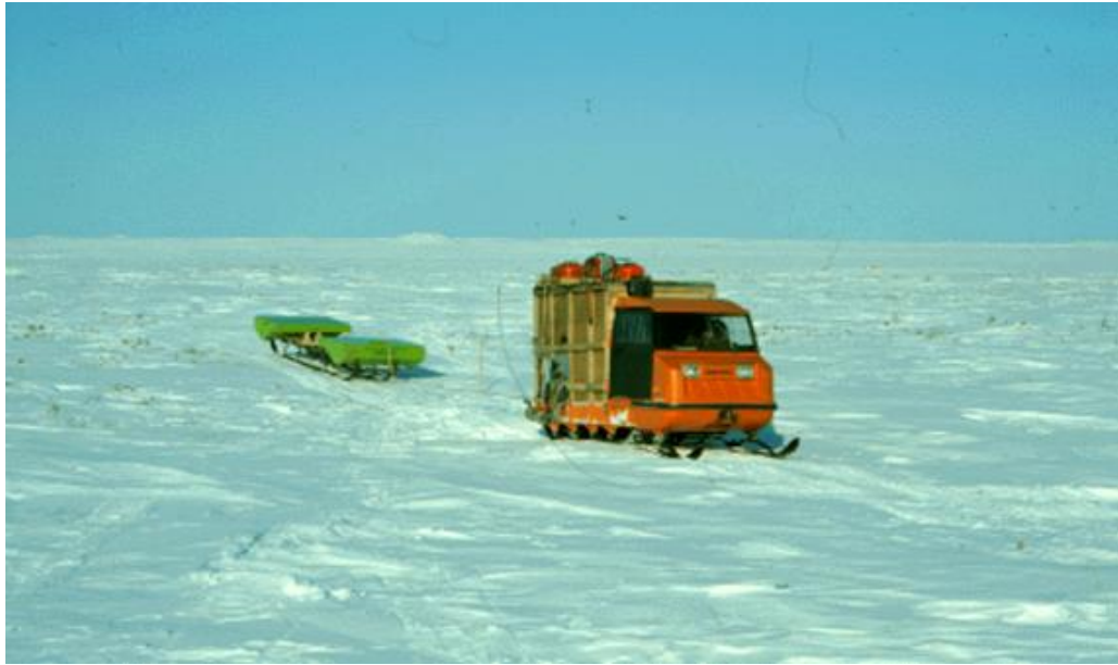
Figura 3 - Sistema GPR usado na prospecção de potenciais vias de instalação de pipelines no Canadá (1975) (ANNAN, 2002).
