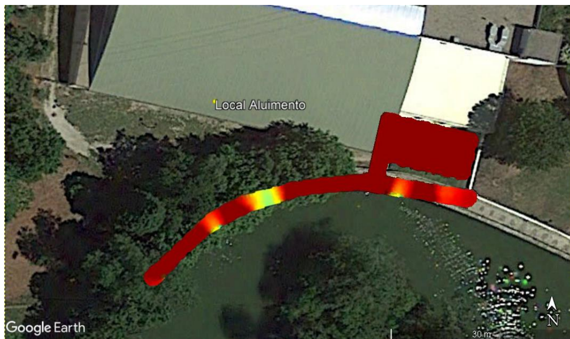
Figura 60 - Zona C - Slice view a 4 metros de profundidade (EKKO Project v.5 e Google Earth Pro).
