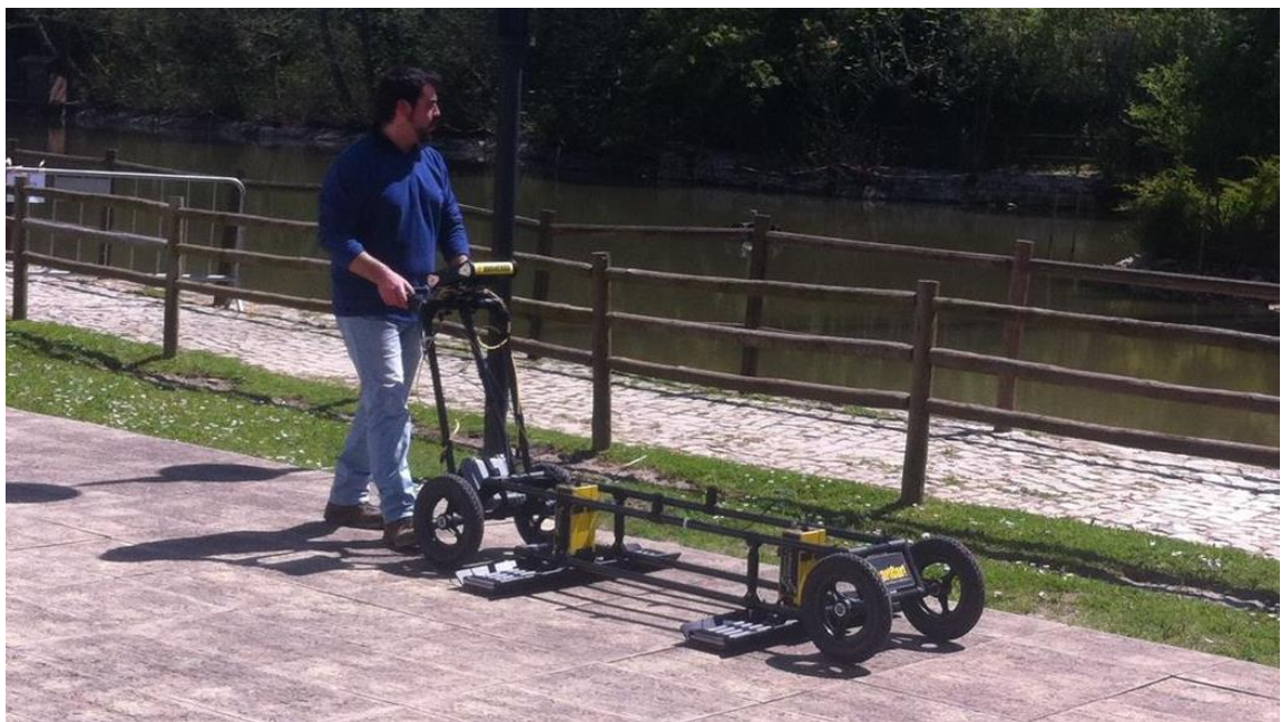
Figura 40 - Equipamento GPR a ser utilizado no dia dos trabalhos (foto do autor, 18 de Abril 2018).
