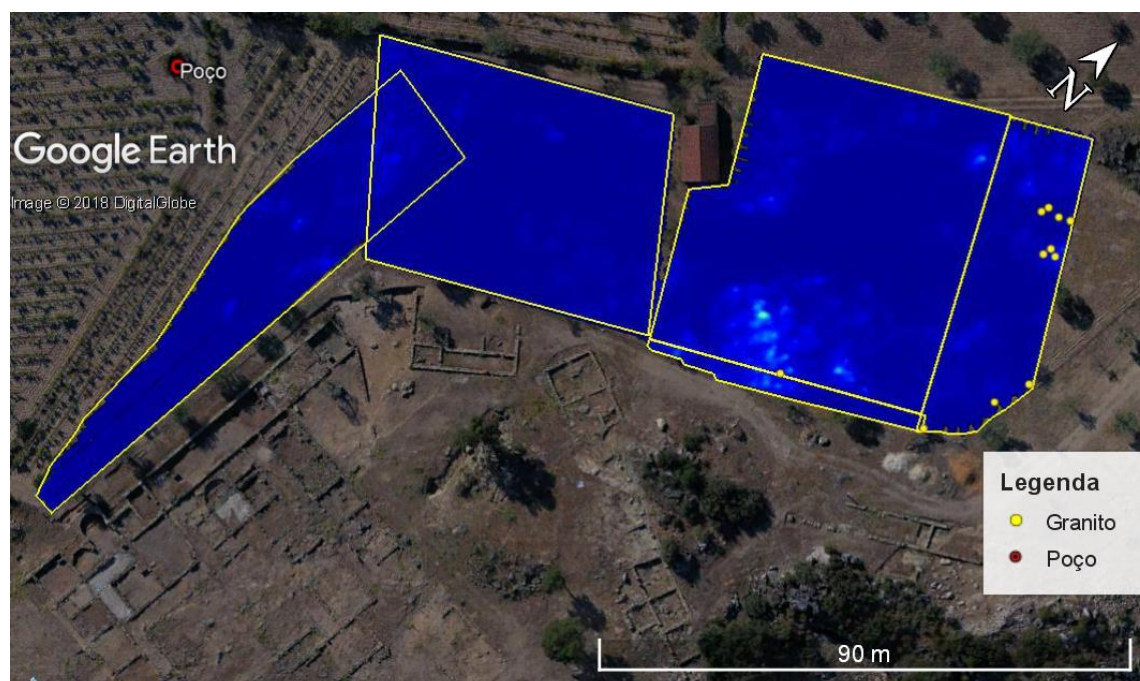
Figura 38 - Plano em profundidade dos dados de GPR (3,990 a 4,085 metros); ( Google Earth Pro , Agosto 2018).
