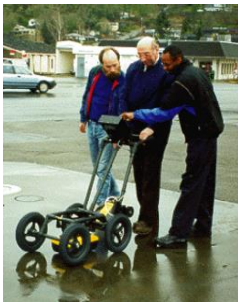
Figura 4 - Equipamento GPR Noggin Smart Cart - Sensors & Software Inc. (ANNAN, 2002).
