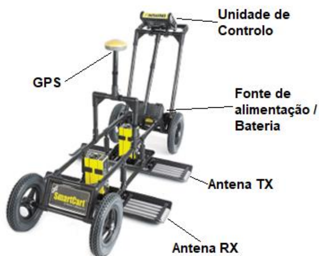
Figura 5 - Equipamento GPR e os seus componentes (adaptado de https://www.sensoft.ca , acedido em 11 de Setembro de 2018).
