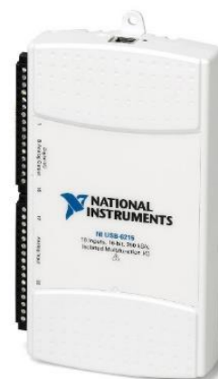
Figura 4.4 – NI USB 6215 com sample rate máxima de 250 kS/s.
