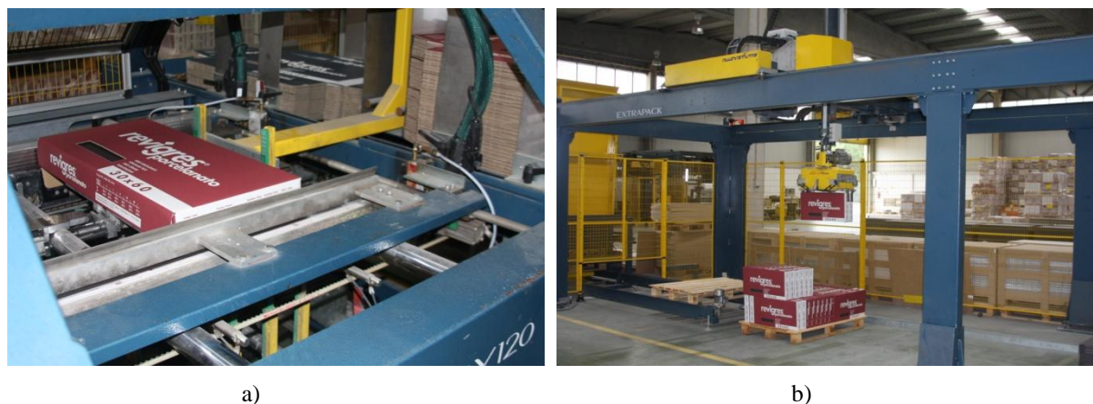
Figura 3.8 – Embalamento e armazenagem do produto final: a) Dispositivo de embalamento ; b) Armazenamento do produto final
