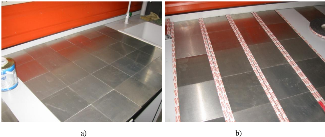
Figura 4.7 – Preparação dos provetes: a) Provetes prontos a serem limpos ; b) Provetes já com a fita dupla-face colada
