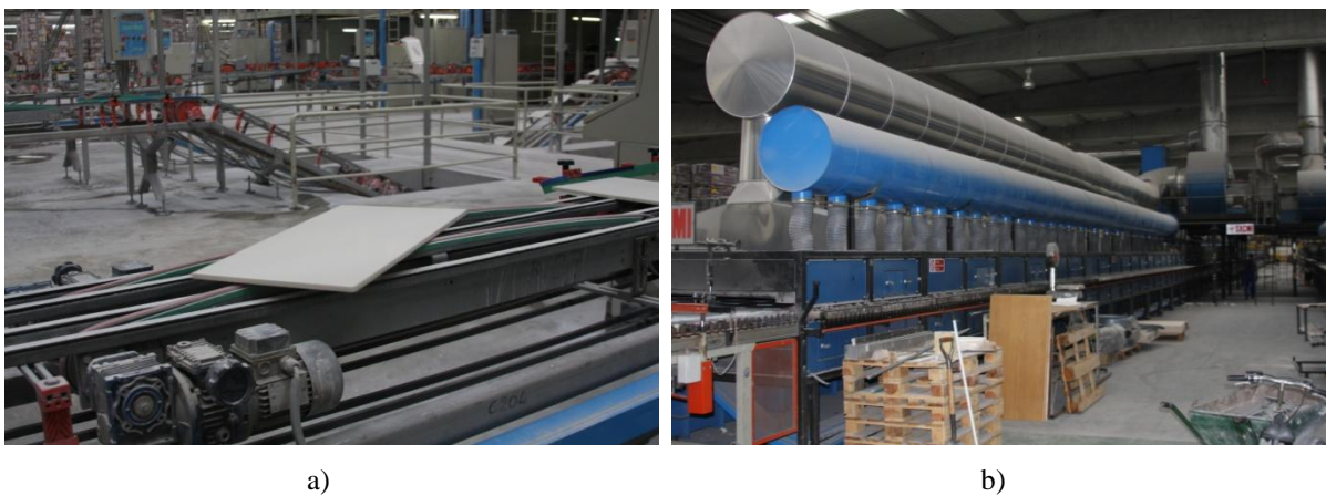
Figura 3.7 - Transporte e cozedura das peças cerâmicas: a) Passadeira de transporte ; b) Forno de cozedura
