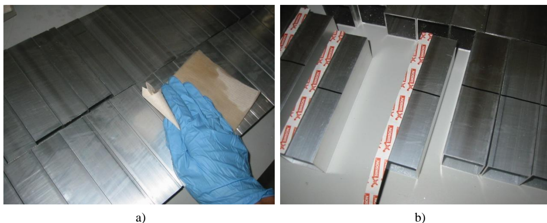
Figura 4.10 – Preparação dos provetes: a) Perfis metálicos a serem limpos com um toalhete embebido em diluente b) Provetes já com a fita dupla face aplicada
