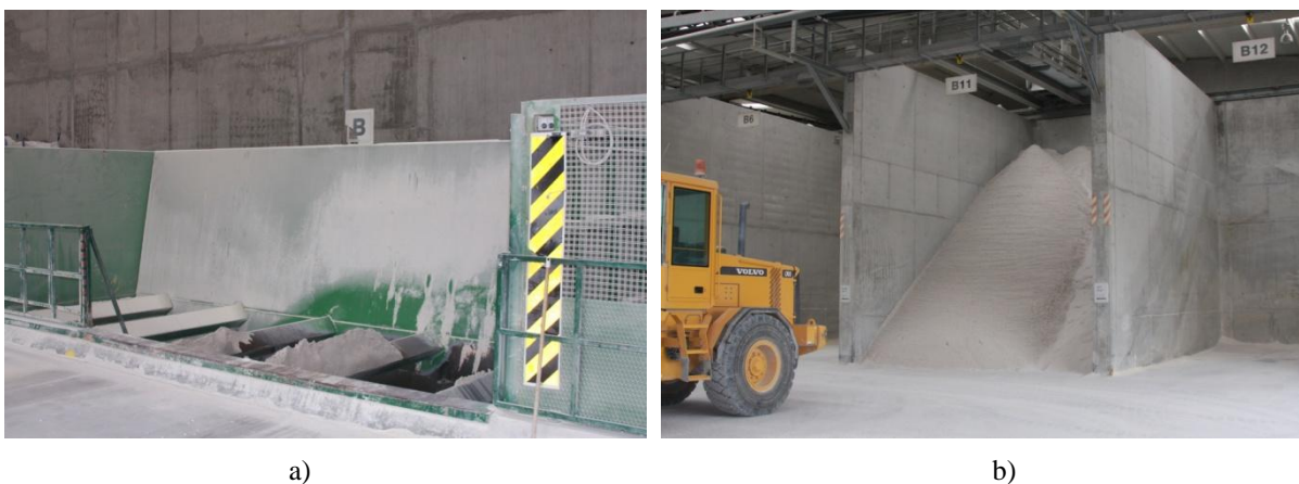
Figura 3.2- Recepção e armazenamento das matérias-primas: a) Zona de recolha de matérias-primas; b) Tulhas de armazenamento
