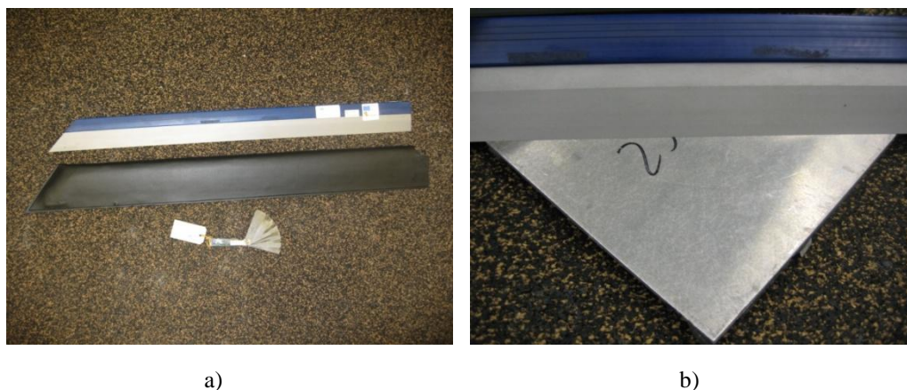
Figura 4.2 – Instrumentos utilizados para confirmar a não existência de empenos na chapa de alumínio: a) Régua biselada e “apalpa-folgas” ; b) Verificação da planeza
