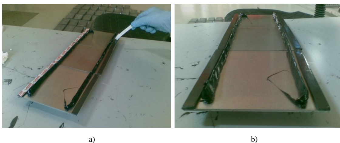
Figura 4.8 – Provetes imediatamente após a aplicação da cola: a) Provetes após aplicação da cola e descolagem da protecção da fita dupla-face ; b) Provetes prontos a serem colados
