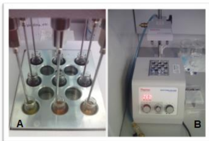
Figura 5 - Procedimento de derivatização: A- secagem dos extratos líquidos através de corrente de azoto; B- derivatização química dos extratos através da reação com BSTFA durante 45 minutos à temperatura de 60°C.
