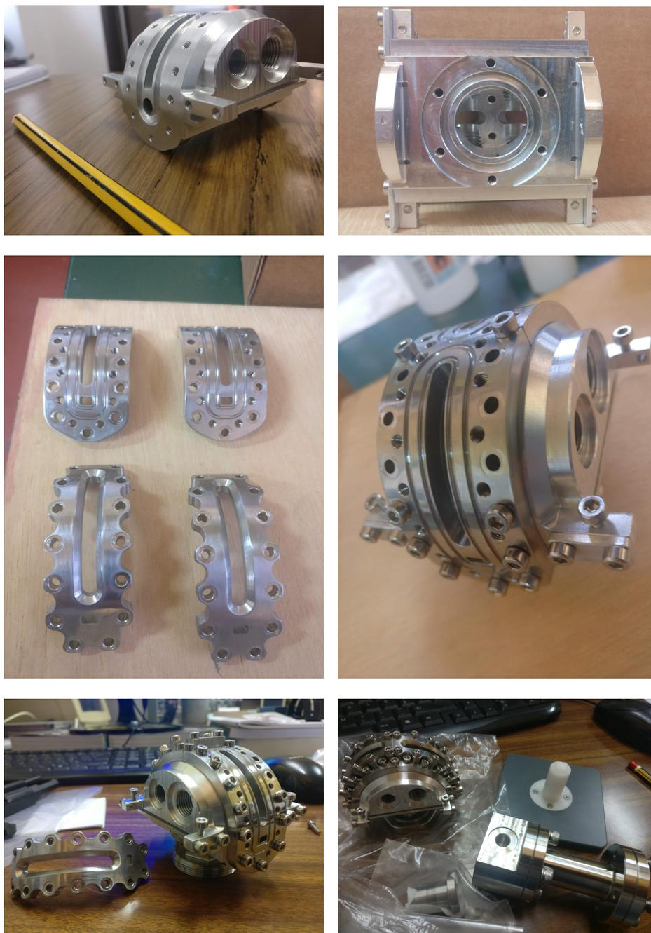
**Figura D.2:** *Fotografias do corpo da câmara e das peças da Sandwich. Na última fotografia podemos ver o volume de referência e o suporte da câmara.*
