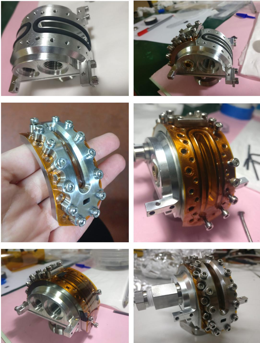
**Figura D.3:** *Montagem do Kapton® na Sandwich da câmara.*
