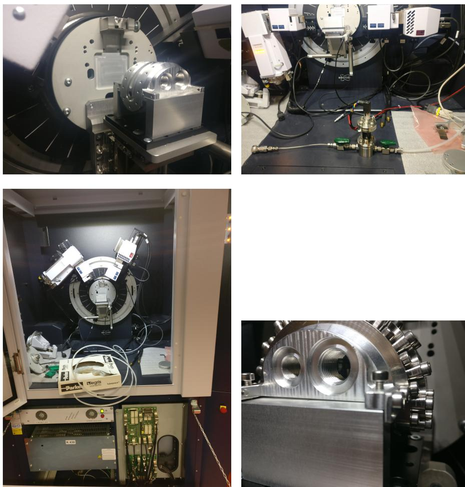
**Figura D.1:** *Câmara e sistema Sieverts no difractor. Desmontagem dos painéis do difractor para passagem do sistema eléctrico e de entrada de gás.*
