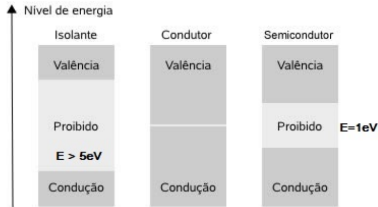
Figura 2.5 Estrutura das bandas de energia nos materiais: isolante, condutor e semicondutor [12].
