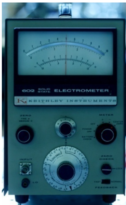
Figura 3.10 Pico-amperímetro da Keithley instruments utilizado na medição da corrente de fuga.
