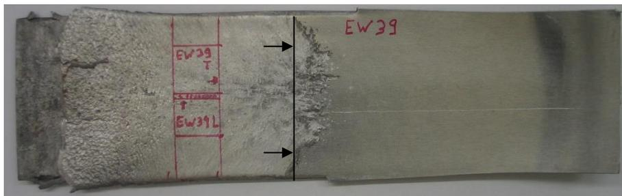
Figura 4.8. Ensaio AA/SS-A20 na posição de impacto.
