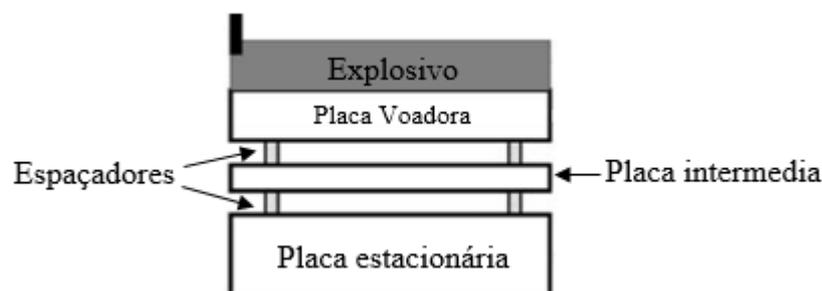
**Figura 2.1.** Montagem em configuração paralela do processo de soldadura por explosão. Adaptada de Han et al. (2003).
