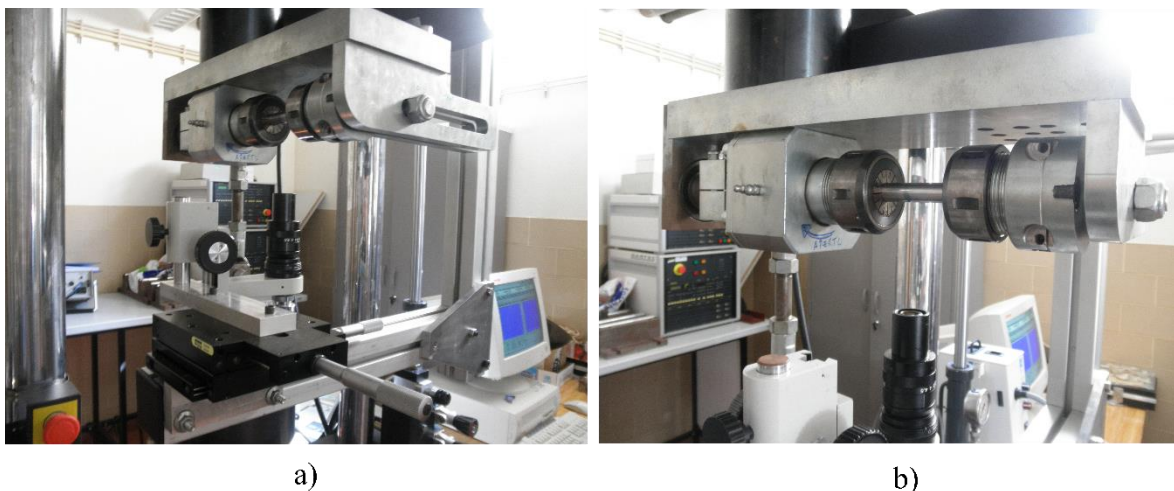
Figura 3.4. Sistema de monitorização digital usado na deteção da iniciação e propagação de fendas por fadiga: a) sistema completo e apoio; b) lente e provete.
