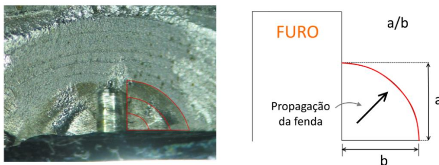
Figura 4.17. Marcas de frente de fenda obtidas no ensaio de marcação com F=T (FT1-3).
