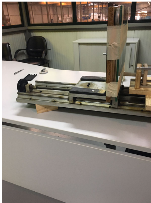
Figura 4.4: Calha de regulação e base móvel
