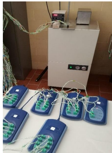
Figura 3.6. Calibração dos 126 termopares.
