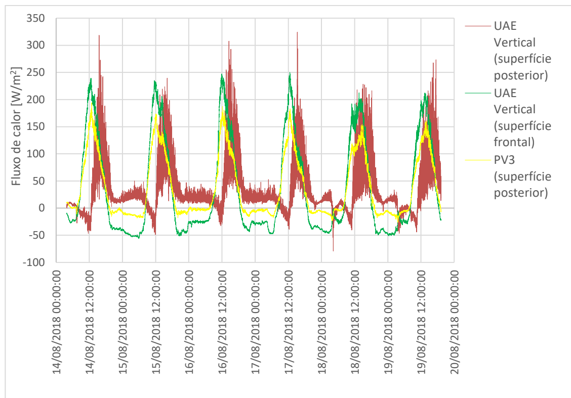
Figura 5.9. Fluxos de calor nas superfícies do sistema PV/PCM3.
