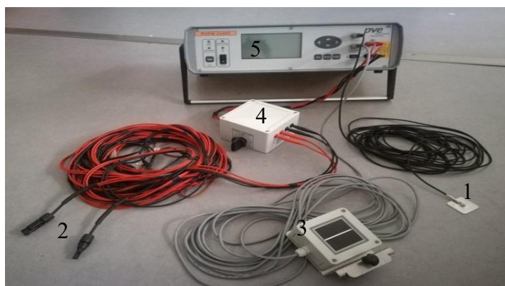
Figura 3.7. Equipamento PVPM2540C utilizado para a caracterização dos painéis PVs utilizados.
