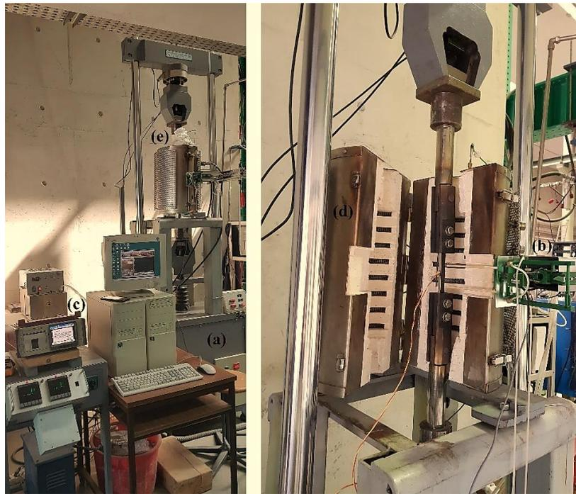
**Figura 3.5.** Configuração do ensaio de temperaturas elevadas. a) Máquina de tração Servosis modelo ME402/20. b) Extensómetro Epsilon modelo HI358. c) TML modelo TDS60. d) Forno elétrico com resistência tubular. e) Fibra cerâmica.
