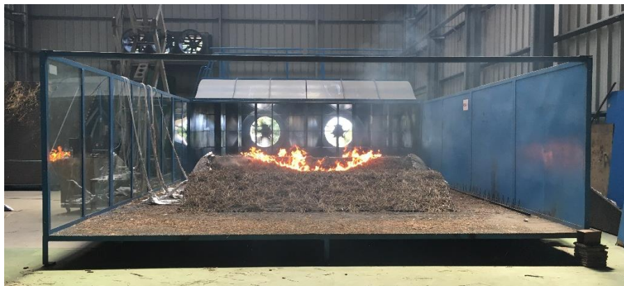
Figura 6 - Túnel de vento do LEIF com colinas
