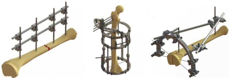
Figura 2.8. Fixador do tipo linear, circular e híbrido, adaptado de [17].
