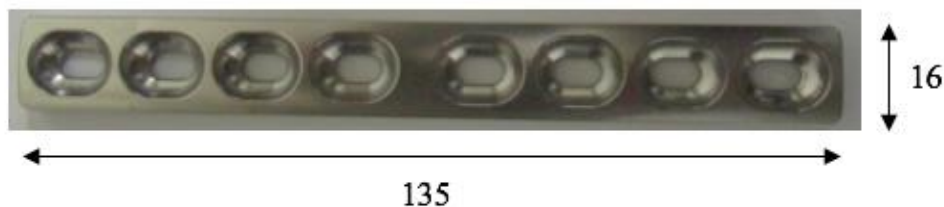
Figura 3.2. Placa de 8 furos ([mm]).
