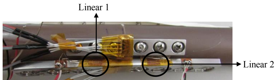
Figura 3.18. Extensómetros lineares nas placas do fémur com fixação dupla.
