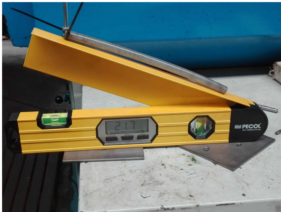
Figura 4.11 -Cálculo experimental do ângulo \alpha .
