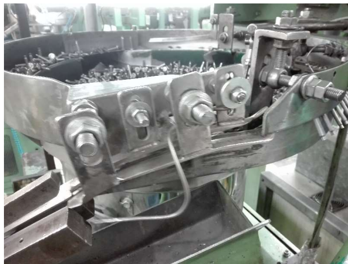
Figura 4.3 - Entrada em régua posteriormente ao vibrador.
