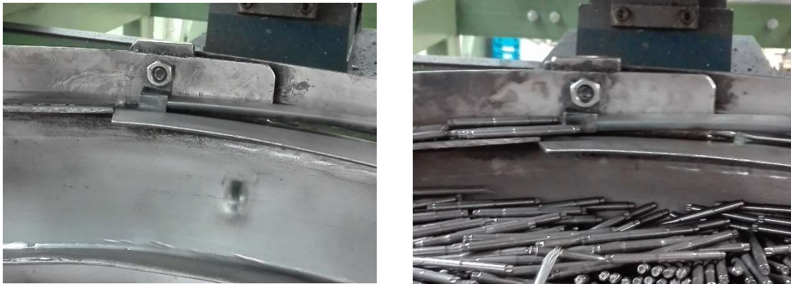
Figura 4.2 - Entrada do tubo, e consequente saída do vibrador.
