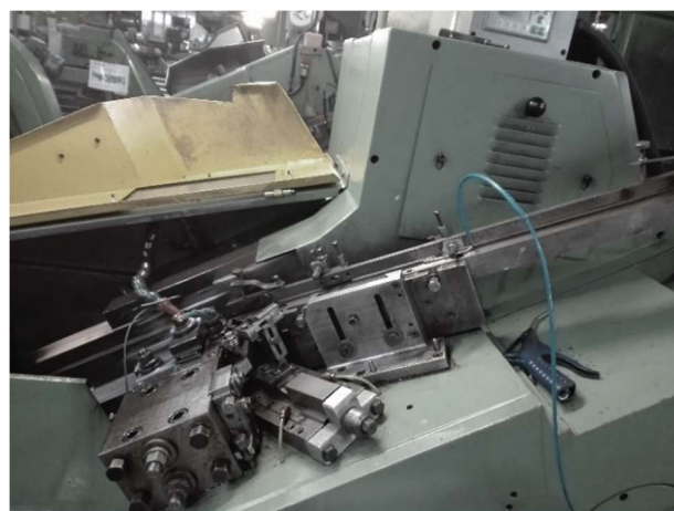
Figura 1.12 - Réguas e sistema de entrada nos pentes de laminagem.
