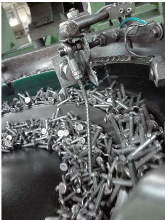
Figura 1.11 - Taça vibratória com revestimento e sensor de contacto.
