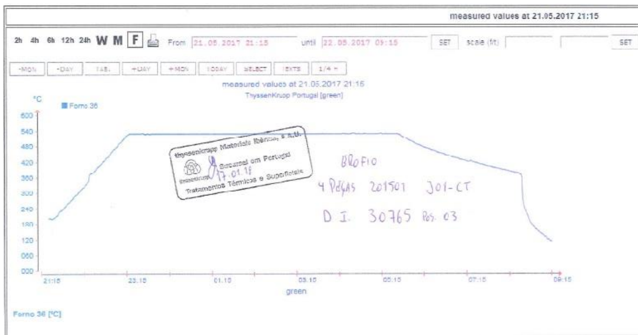
Anexo A1 - Esquema da temperatura em função do tempo, correspondente ao tratamento térmico de envelhecimento.
