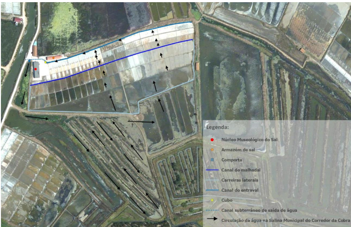
Figura 4 – Esquema de circulação de água na Salina Municipal do Corredor da Cobra sobre fotografia aérea.
