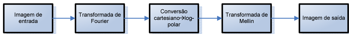
Figura 30: Representação genérica do fluxo do algoritmo associado ao cálculo da transformada de Fourier-Mellin. Adaptado de [77].
