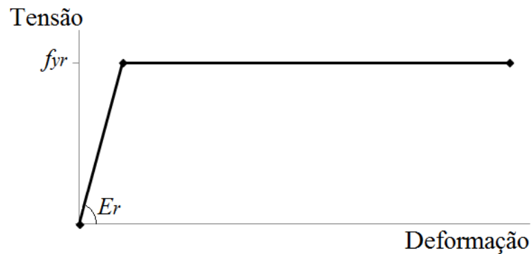
Figura 3.9 - Diagrama de tensão versus deformação para as barras de armadura de aço.
