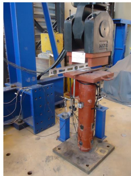
Figura 2.50 – Ensaio de cisalhamento de PMPC utilizando parafusos de alta resistência como conectores de cisalhamento (Cardoso, 2014): (a) detalhes dos modelos das séries G e H; (b) modelo instrumentado.
