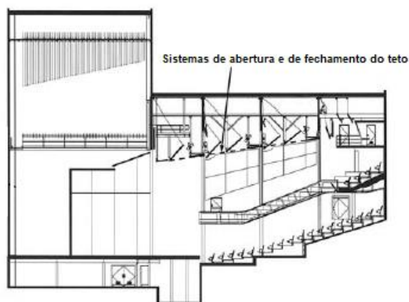
Figura 3.2 - Teatro Bruce Mason, Auckland, Nova Zelândia mostrando o uso de painéis articuláveis no teto (Barron, 2009)
