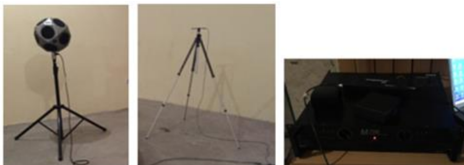
Figura 5.3 - Equipamentos utilizados durante o ensaio, da esquerda para a direita Fonte sonora omnidirecional, Microfone, Symphonie
