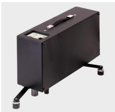
Figura 3.1 - Máquina de Percussão Normalizada. Fonte: Site [www.bksv.com](http://www.bksv.com).
