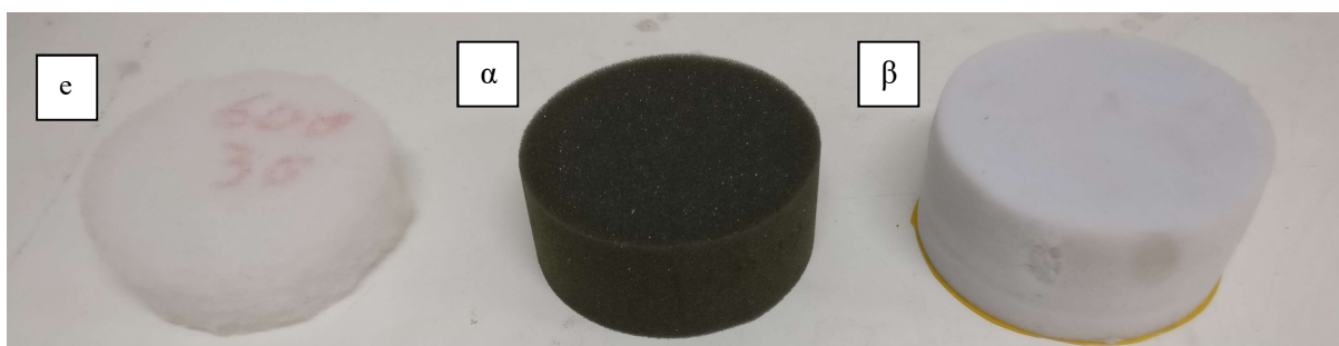
Figura 4.8 – Material absorvente fibroso e poroso, fibra de poliéster e espumas poliuretano flexível célula aberta.
