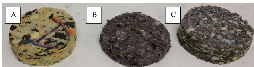
Figura 4.9 – Material absorvente fibroso, aglomerados de espumas e aglomerado de fibras de tecido.
