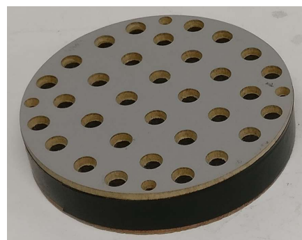
Figura 5.5 – Painel MDF microperfurado com placa macroperfurada no tardo com diâmetro de \varnothing = 8mm .
