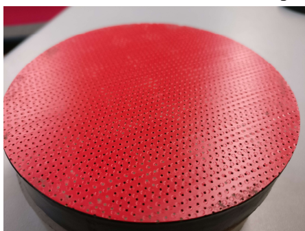
Figura 5.4 – Painel MDF com revestimento em termolaminado microperfurado com diâmetro de perfuração de \varnothing = 0,5mm .
