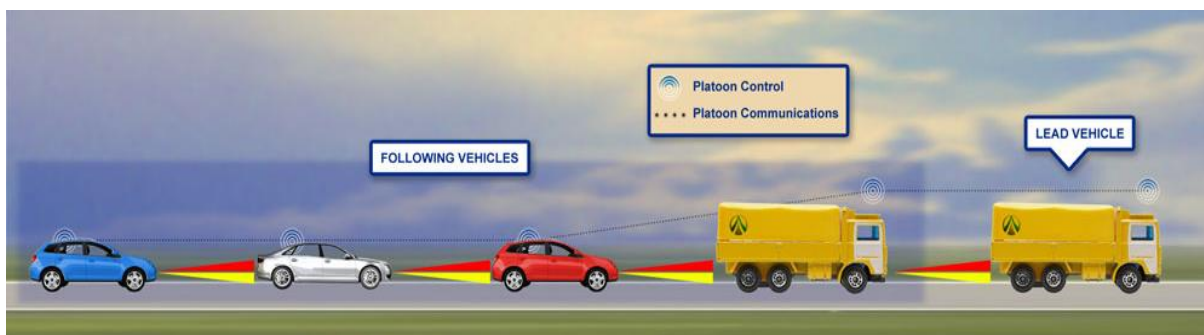
Figura 2.17 - Exemplificação do conceito platooning (@driverless, 2015)
