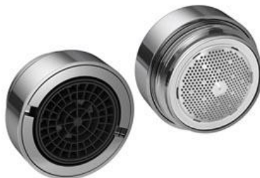
Figura A. 8 - Arejador (SustentArqui). Através da aplicação deste equipamento, irá haver uma mistura de água e ar, o que irá diminuir o caudal de água embora mantendo a mesma sensação, resultando, previsivelmente, numa redução do consumo de água.
