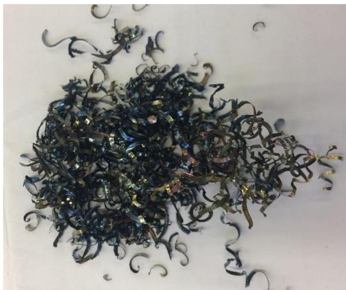
**Figura 3.4-** Foto das aparas após tratamento térmico.
