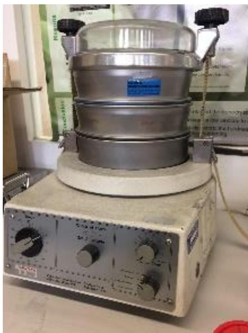
**Figura 2.2-Equipamento Vibratory Sieve Shaker, Analysette 3, da Fritsch.**
