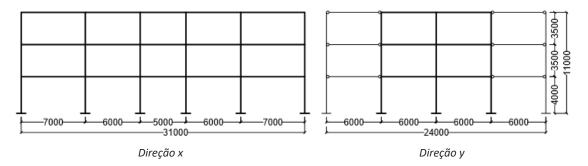
Figura 4.2- Configuração vertical dos pórticos rígidos correspondentes a um edifício de 3 pisos
