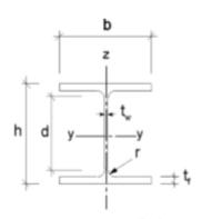
Figura 3.1- Representação dos eixos dos elementos
