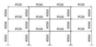
Figura 4.14- Pré-dimensionamento do pórtico na direção y do edifício de 3 pisos, caso de estudo 2
