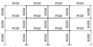
Figura 4.8- Solução final do pórtico na direção y do edifício de 3 pisos, caso de estudo 1
