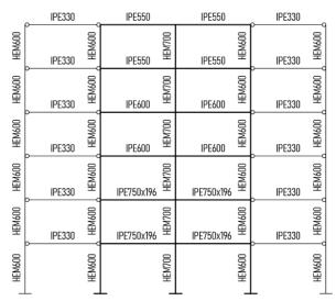
Figura 4.5- Solução final do pórtico na direção y do exemplo de referência
