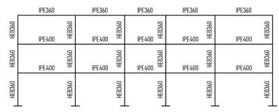
Figura 4.13- Pré-dimensionamento do pórtico na direção x do edifício de 3 pisos, caso de estudo 2
