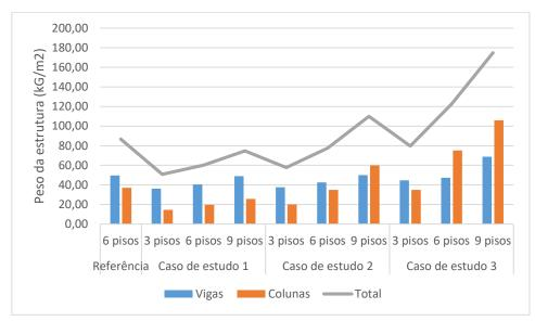
Figura 5.3- Comparação das quantidades de aço das estruturas estudadas ao nível das vigas e das colunas
