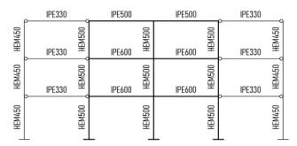
Figura 4.22- Solução final do pórtico na direção y do edifício de 3 pisos, caso de estudo 3
