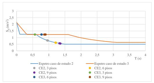
Figura 5.2- Períodos fundamentais e respostas estruturais das estruturas estudadas e respetivos espetros de resposta
