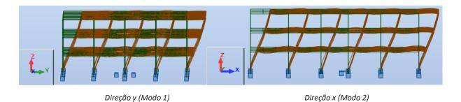
Figura 4.15- Modos de vibração fundamentais
