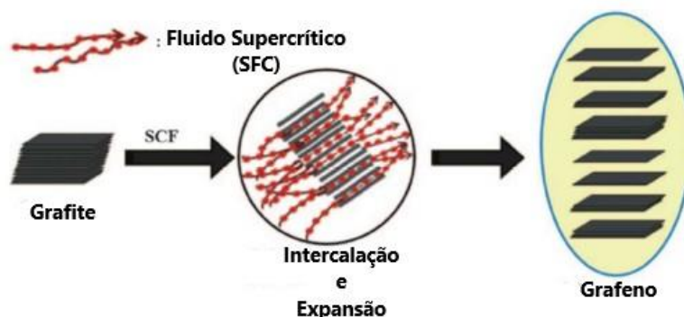
Figura 1.6 - Vias de exfoliação por fluido supercrítico [60]
