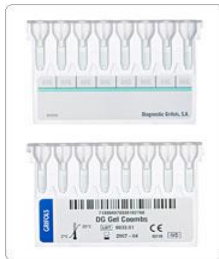
Figura 11: Placa de DG Gel onde decorre o teste de Coombs. (Adaptado de http://www.grupolabca.com.mx/laboratorios%20clinicos/Licon/banco%20de%20sangre/Tarjeta%20Gel/Tecnica%20tarjeta%20gel%20reactivos.htm 04/06/2018)
