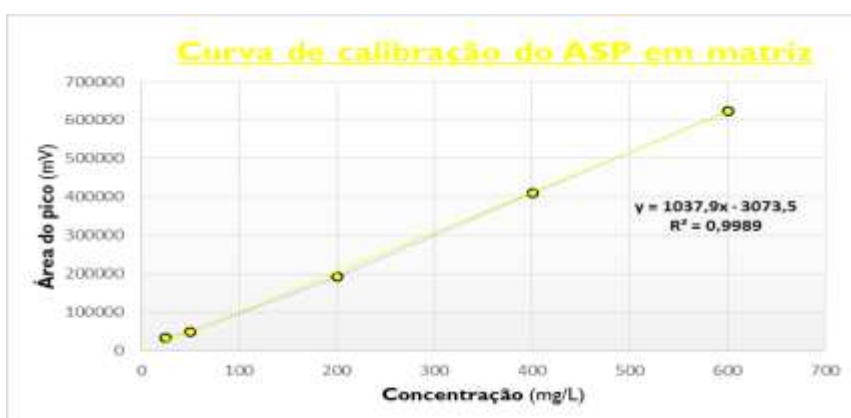
Figura 26. Curva de calibração do aspártamo em matriz. Área do pico cromatográfico, em mV, representado no eixo dos yy e a concentração deste edulcorante, em mg/L, no eixo dos xx.
