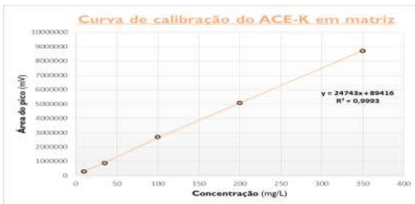
Figura 24. Curva de calibração do acessulfame - K em matriz. Área do pico cromatográfico, em mV, representado no eixo dos yy e a concentração deste edulcorante, em mg/L, no eixo dos xx.
