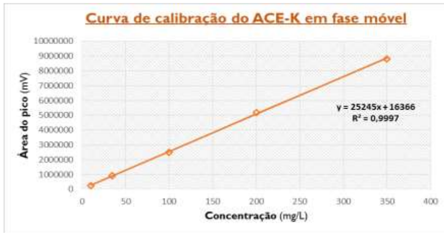
Figura 21. Curva de calibração do acessulfame – K em fase móvel. Área do pico cromatográfico, em mV, representado no eixo dos yy e a concentração deste edulcorante, em mg/L, no eixo dos xx.
