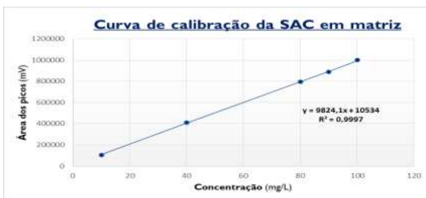
Figura 25. Curva de calibração da sacarina em matriz. Área do pico cromatográfico, em mV, representado no eixo dos yy e a concentração deste edulcorante, em mg/L, no eixo dos xx.
