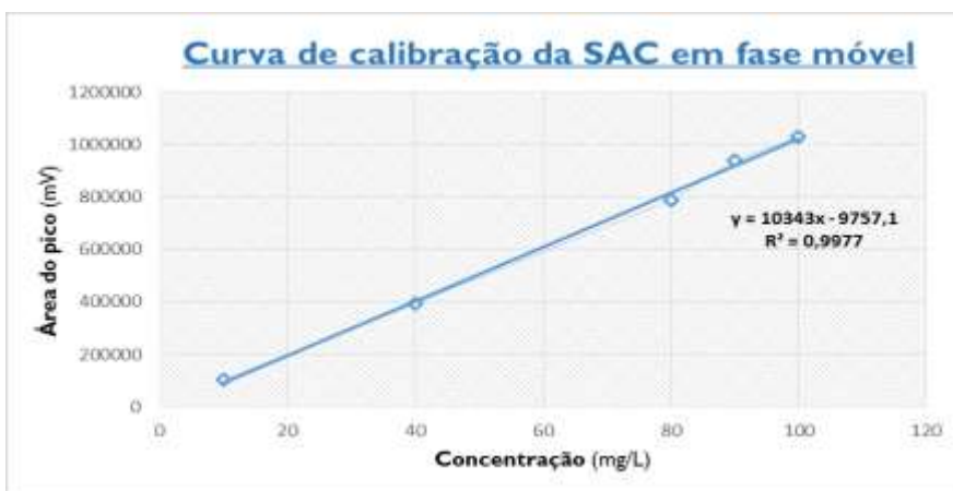
Figura 21. Curva de calibração do acessulfame – K em fase móvel. Área do pico cromatográfico, em mV, representado no eixo dos yy e a concentração deste edulcorante, em mg/L, no eixo dos xx.
