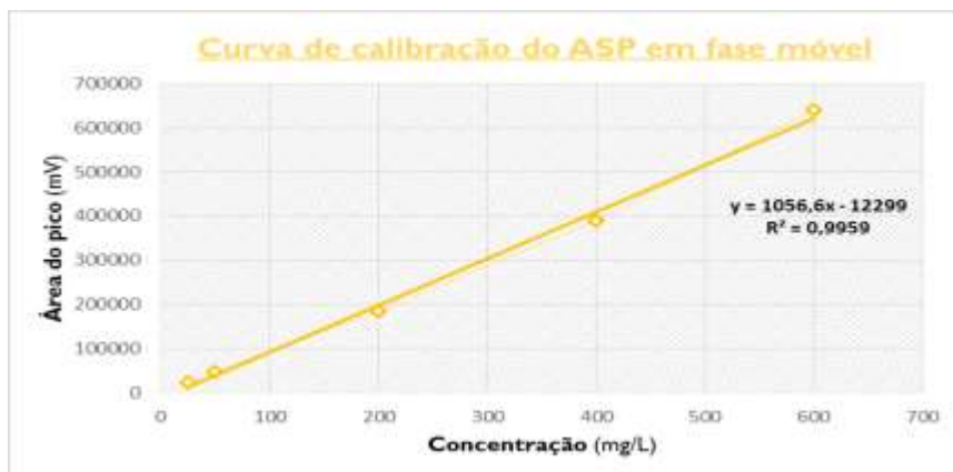
Figura 23. Curva de calibração do aspártamo em fase móvel. Área do pico cromatográfico, em mV, representado no eixo dos yy e a concentração deste edulcorante, em mg/L, no eixo dos xx.
