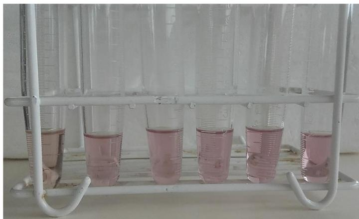
**Figura nº10-** Preparação das diluições com quantidades distintas de Trolox para a construção da curva de padrão.
