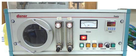
**Figura 2.2:** Equipamento para modificação de superfícies por plasma do DEQ.
