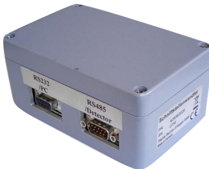
Figura 10 - Conversor RS-485/RS-232 – USB
