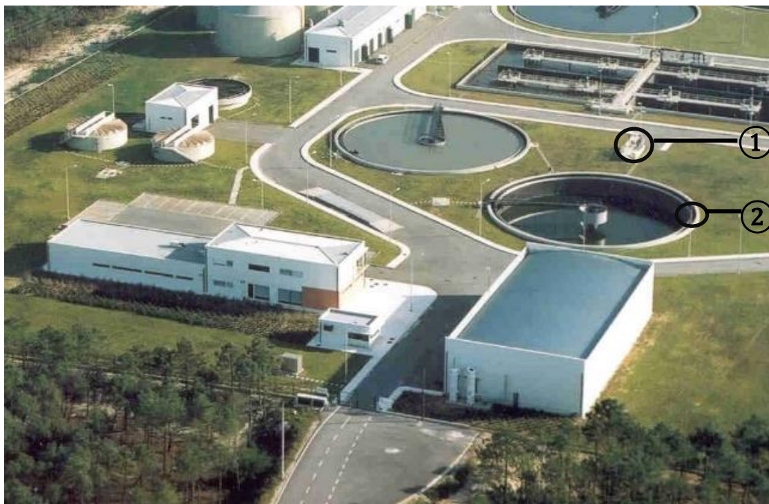
Figura 5.1 – Locais de amostragem de clarificado do decantador primário e de lamas primárias na câmara de lamas primárias (SL1).
