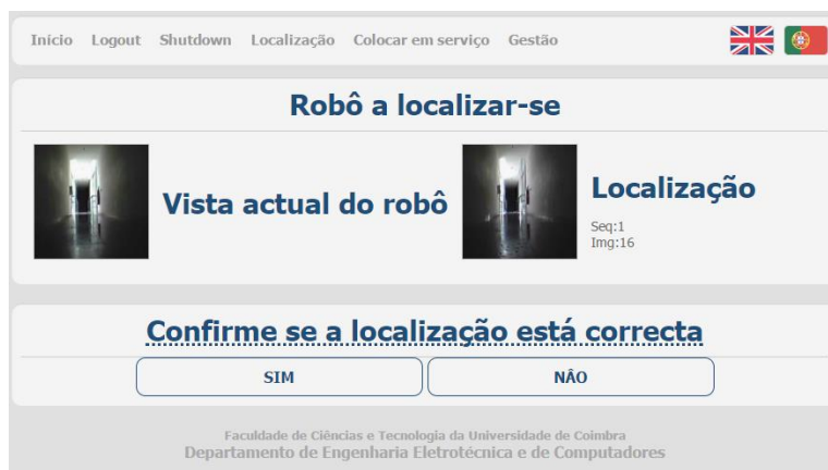
Figura 6. 2 - Auto localização, colocação do robô em modo de serviço
