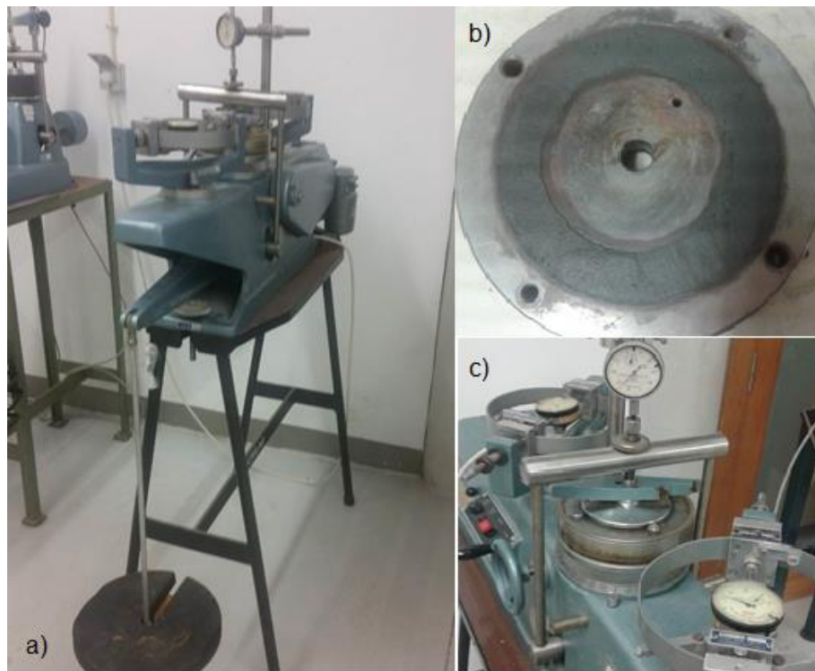
Figura 4.1 – Caixa de corte anelar rotativo: a) aspecto geral, b) pormenor da caixa de Bromhead. c) dispositivos que registam a deformação vertical e a força resistente ao corte.
