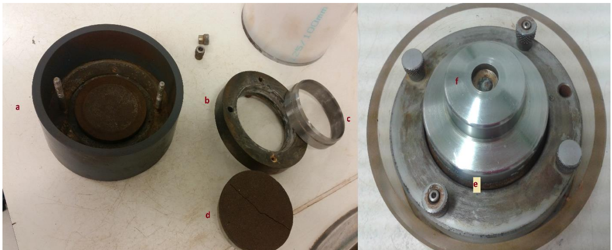
Figura 4.6 – Partes constituintes da célula edométrica: a) Célula edométrica; b) Peça de fixação do anel; c) Anel Edométrico; d) Pedra porosa inferior; e) Pedra porosa superior; f) Peça para distribuir a carga uniformemente por toda a área da amostra.
