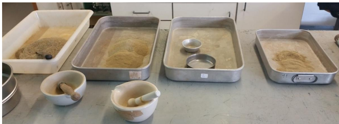
Figura 5.2 – Procedimento de preparação das amostras: tabuleiros e almofarizes: a) Amostra de Xisto Negro; b) Amostra de Xisto Castanho.
