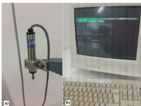
Figura 4.4 – a) LVDT (transdutor). b) Computador para registo dos dados automáticos.
