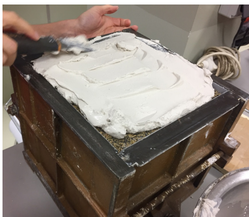
Figura 3.11 - Colocação da camada de gesso no provete
