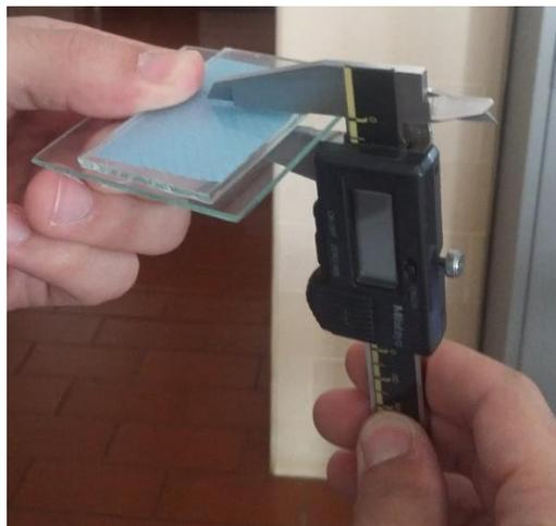
**Figura 2.12.** Imagem ilustrativa da medição da espessura das amostras.
