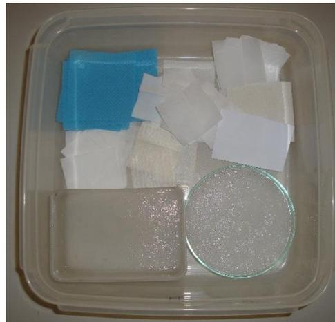
**Figura 2.10.** Exemplo de amostras em ambiente controlado de humidade relativa via solução salina saturada.
