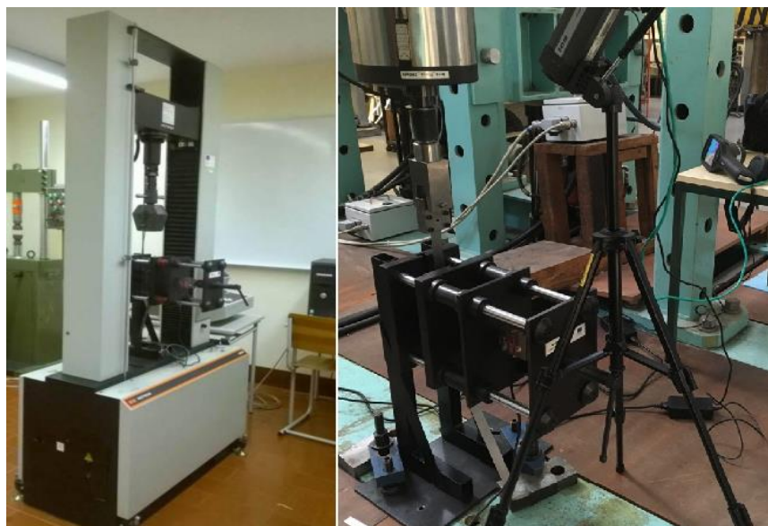
Figura 2.2 - Montagem do equipamento de ensaio de atrito com freio: À direita: máquina de ensaios de tração do DEM; À esquerda: máquina SIFAMA do IDMEC.
